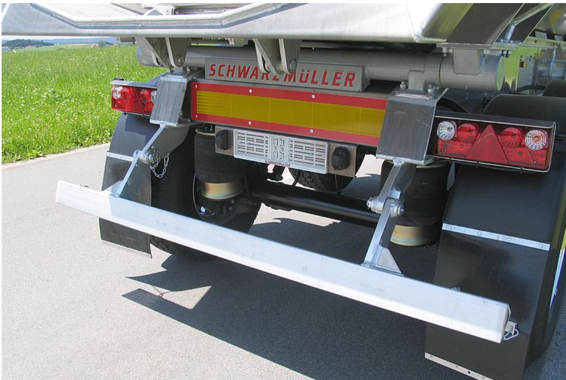
Aluminiowa osłona przeciwnajazdowa, trapezowa, składana
