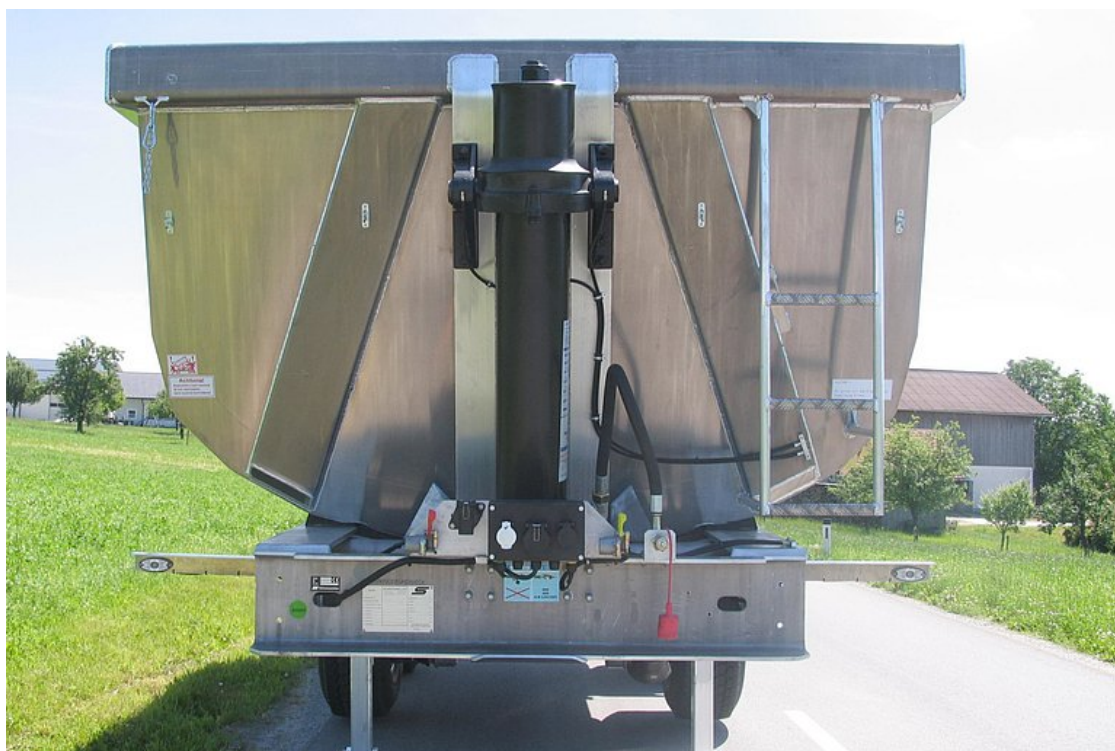
Ściana przednia pod kątem z chromowanym na twardo, wysokiej jakości przednim siłownikiem przechyty
