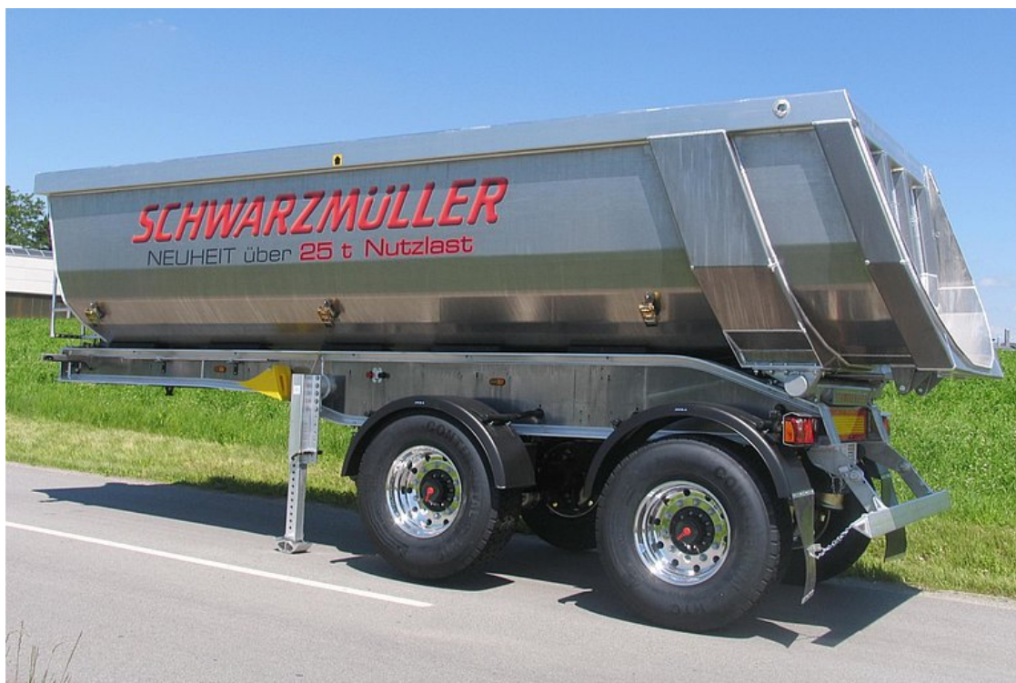
2-osiowa naczepa siodłowa wywrotka w całości aluminiowa ze skrzynią segmentową - rozstaw osi 1 810 mm
