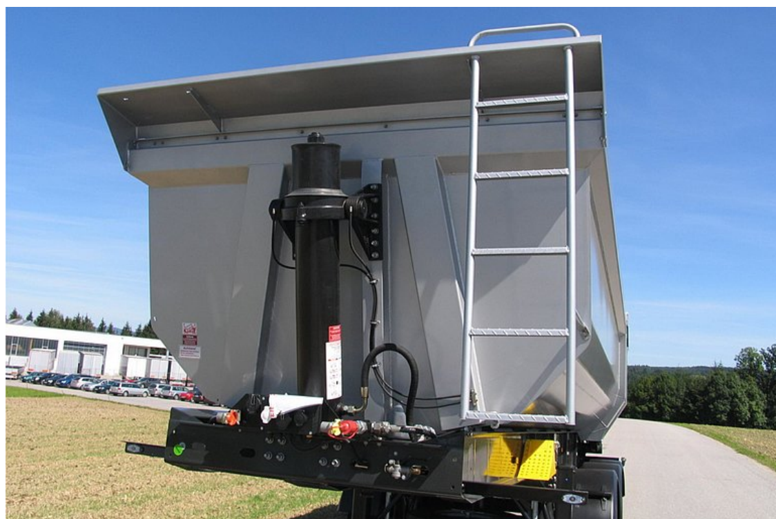
Optymalny rozkład obciążenia dzięki pochyłej ścianie przedniej
