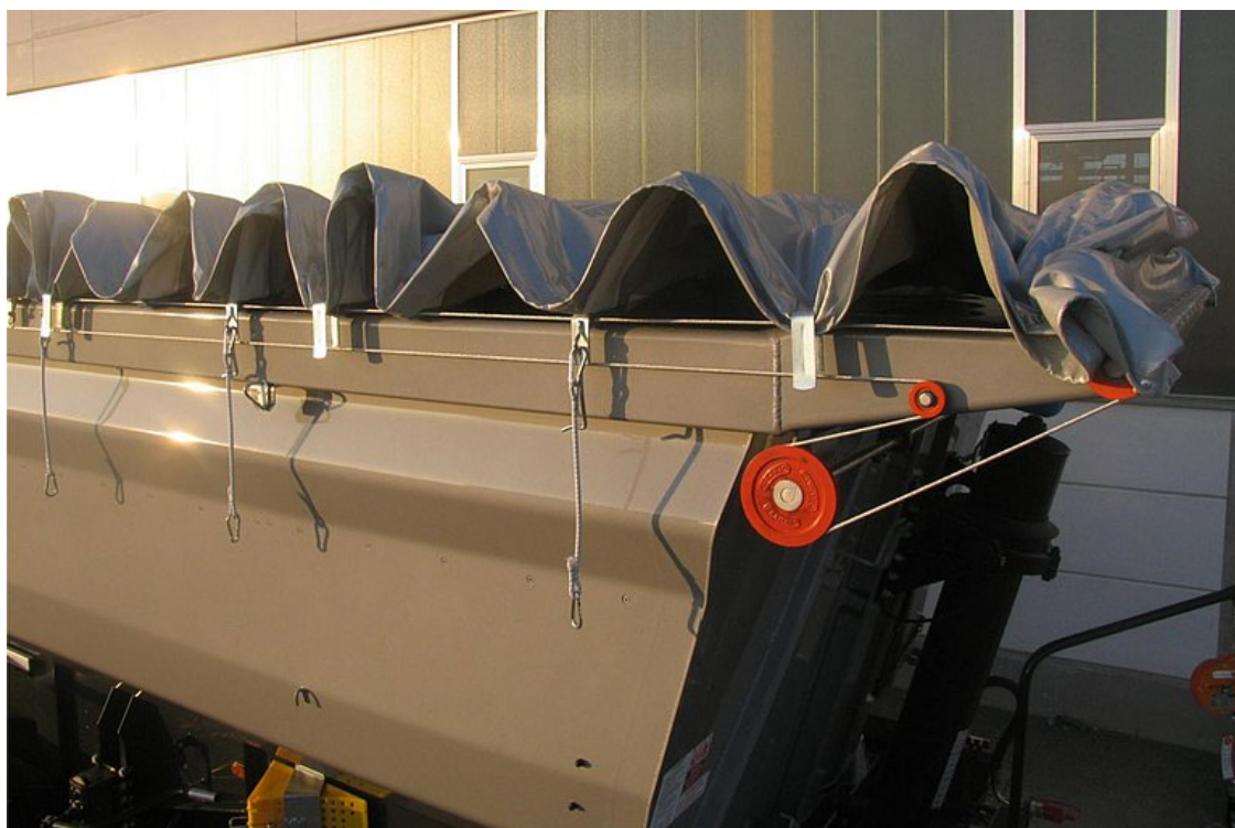
Dach rolkowy - może być obsługiwany ręcznie lub elektrycznym pilotem zdalnego sterowania
