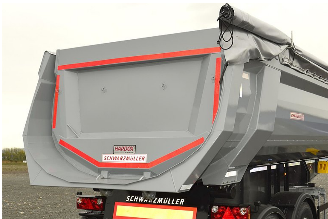
Stalowa ściana tylna = ściana wahliwa z wpuszczonymi łożyskami i automatycznym mechanicznym centralnym zamknięciem 2-hakowym
