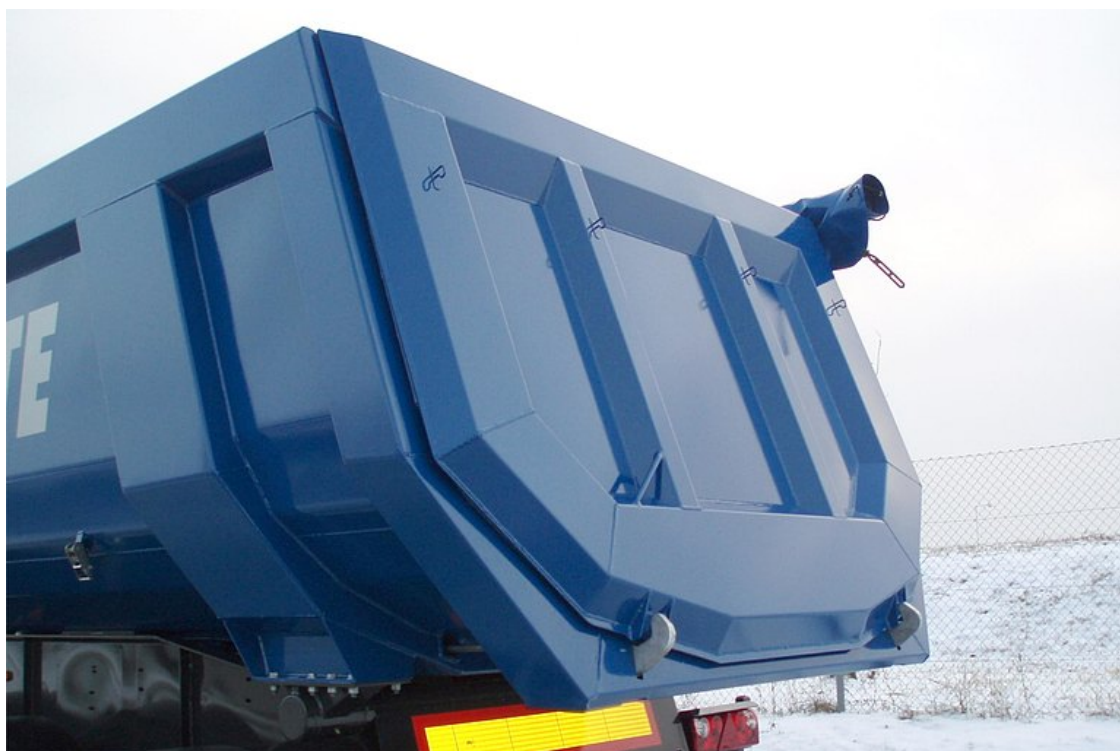
OPCJONALNIE: leżąca na zewnątrz tylna ściana - dzięki temu zapewniona większa pojemność ładunkowa
