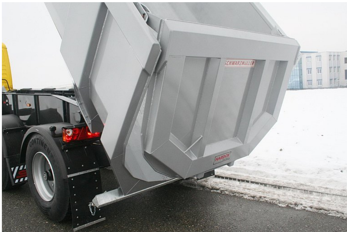
Tylna ściana = ściana wahlowa z wpuszczonymi łożyskami i automatycznym mechanicznym centralnym zamknięciem 2-hakowym
