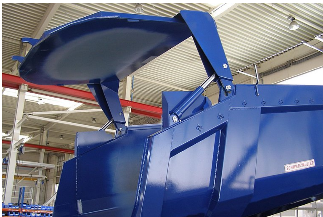
OPCJONALNIE: specjalna wahlowa ściana tylna do bardzo dużego otworu z wpuszczonym łożyskami i automatycznym uruchamianiem hydraulicznym
