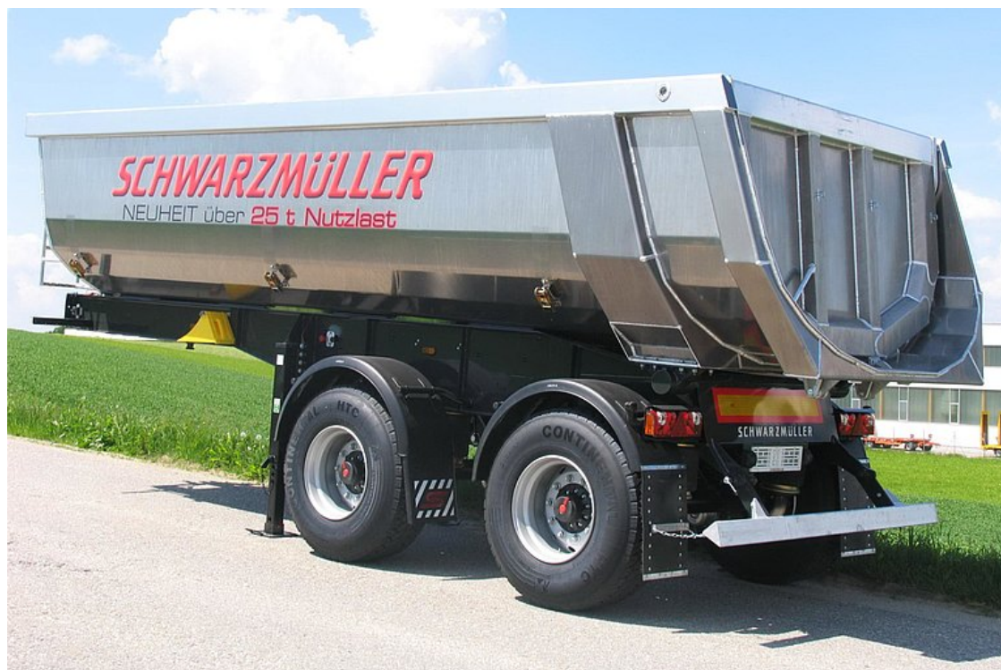
2-osiowa naczepa siodłowa wywrotka aluminiowa ze skrzynią segmentową - rozstaw osi 1 810 mm
