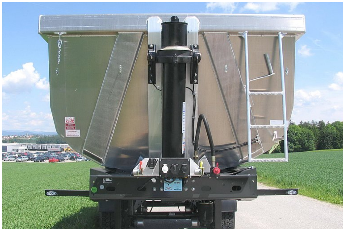
Ściana przednia pod kątem z chromowanym na twardo, wysokiej jakości przednim siłownikiem przechyłu
