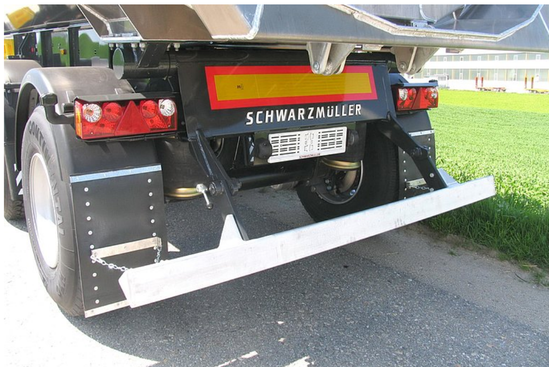
Aluminiowa osłona przeciwnajazdowa, trapezowa, składana
