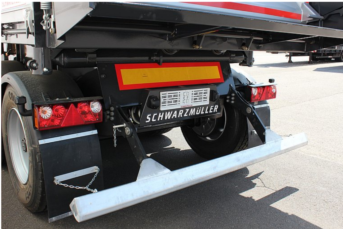
Składana osłona przeciwnajazdowa w przypadku użycia układarki
