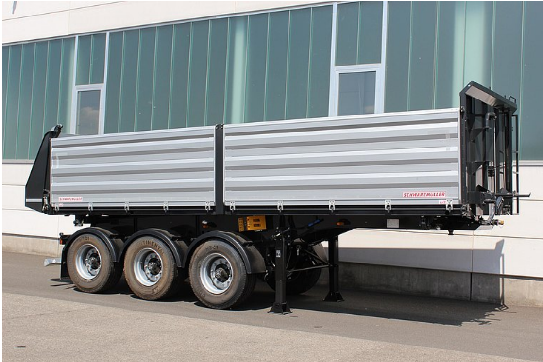
3-osiowa naczepa siodłowa wywrotka trójstronna na budowę
