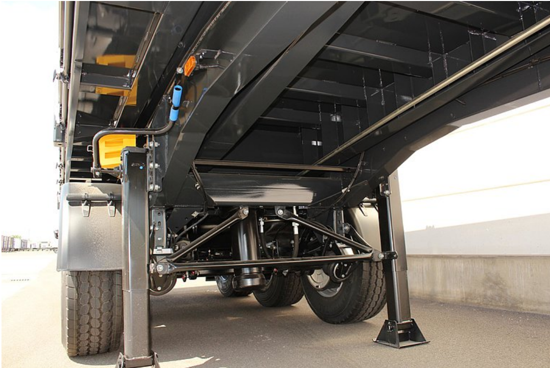
Stabilna i odporna na skręcanie konstrukcja podwozia z dodatkowymi rurami skrętnymi do wywrotu trójstronnego
