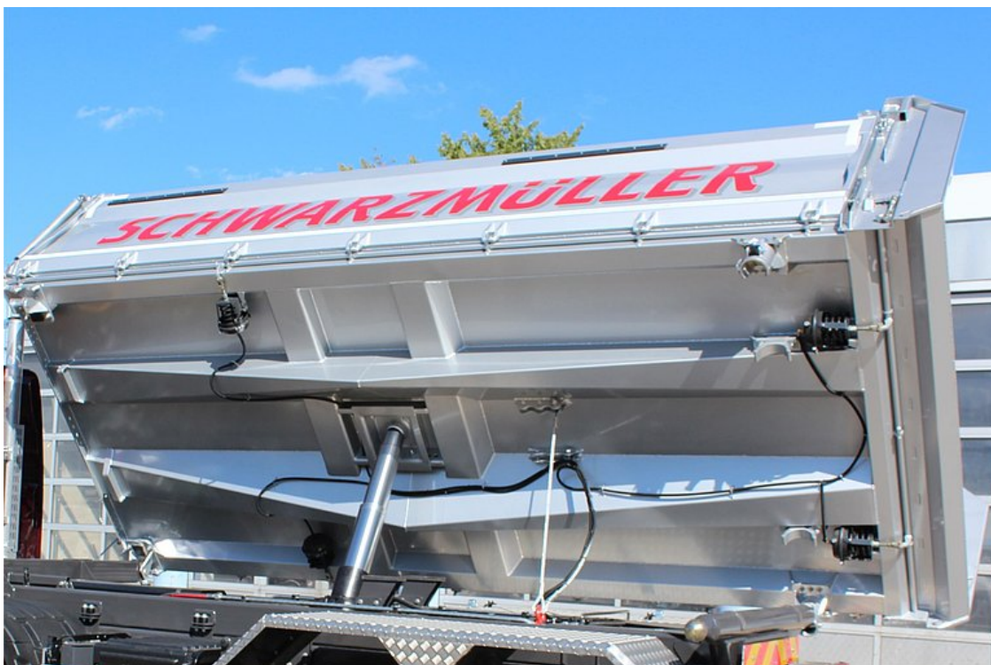
Podłużnice stożkowe o profilu trapezowym lekkiej konstrukcji i dużej wytrzymałości z małymi polami podłogi zapewniają wysoką odporność na wyboczenie i wysokie sprężynowanie uderzeń
