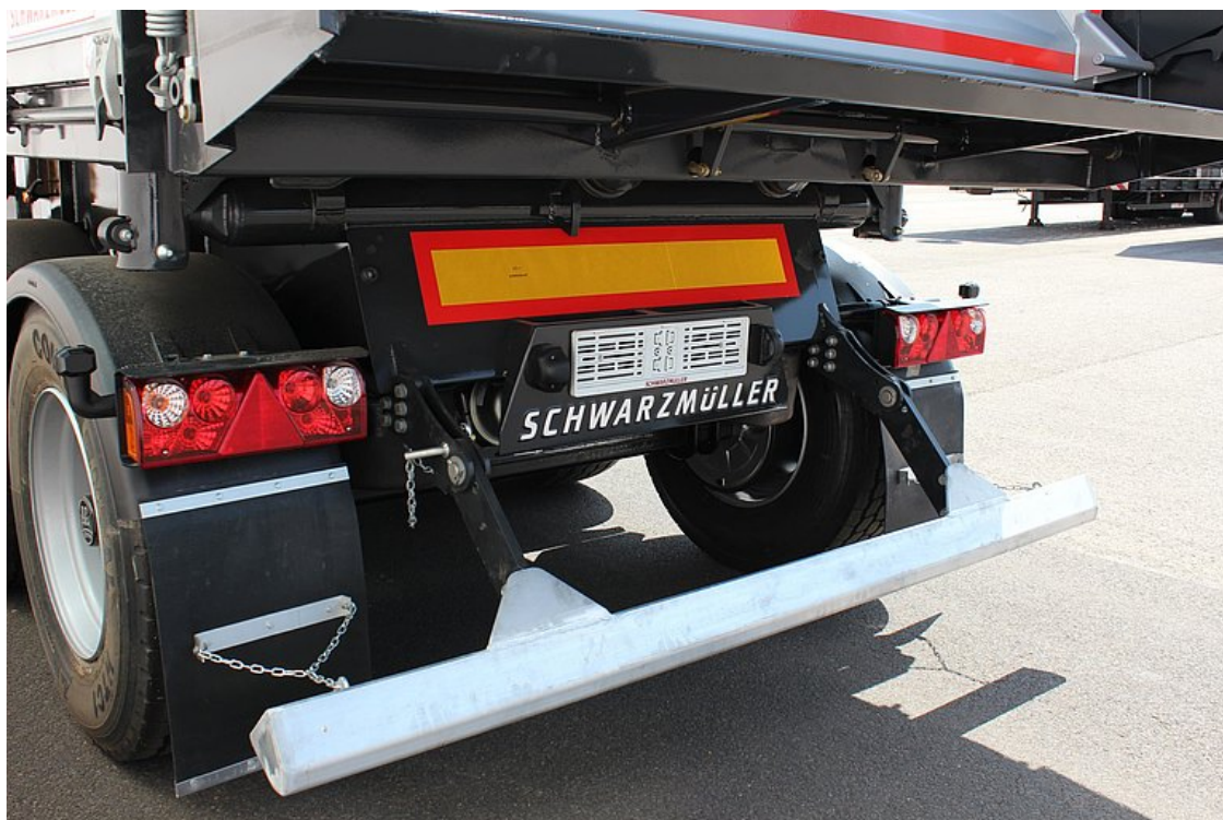
Składana osłona przeciwnajzdowa w przypadku użycia układarki
