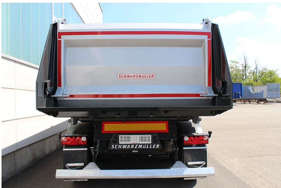
Tylna ściana z blachy stalowej, może być uchylana ze zwiększonym ułożyskowaniem i automatycznym zamknięciem pneumatycznym
