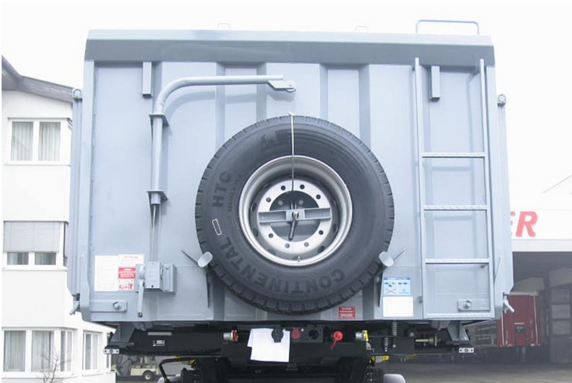
OPCJONALNIE: uchwyt na koło zapasowe z obrotowym wysięgnikiem i wyciągarką na przedniej ścianie
