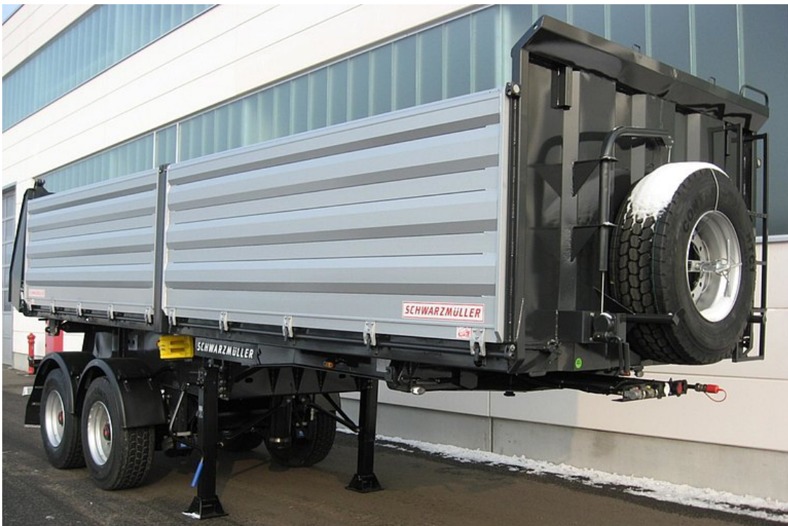
2-osiowa naczepa siodłowa wywrotka trójstronna na budowę, wzmocnione osie
