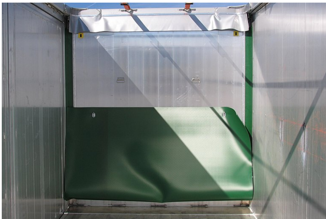
Przesuwana ścianka pośrednia z plandeką wleczoną
