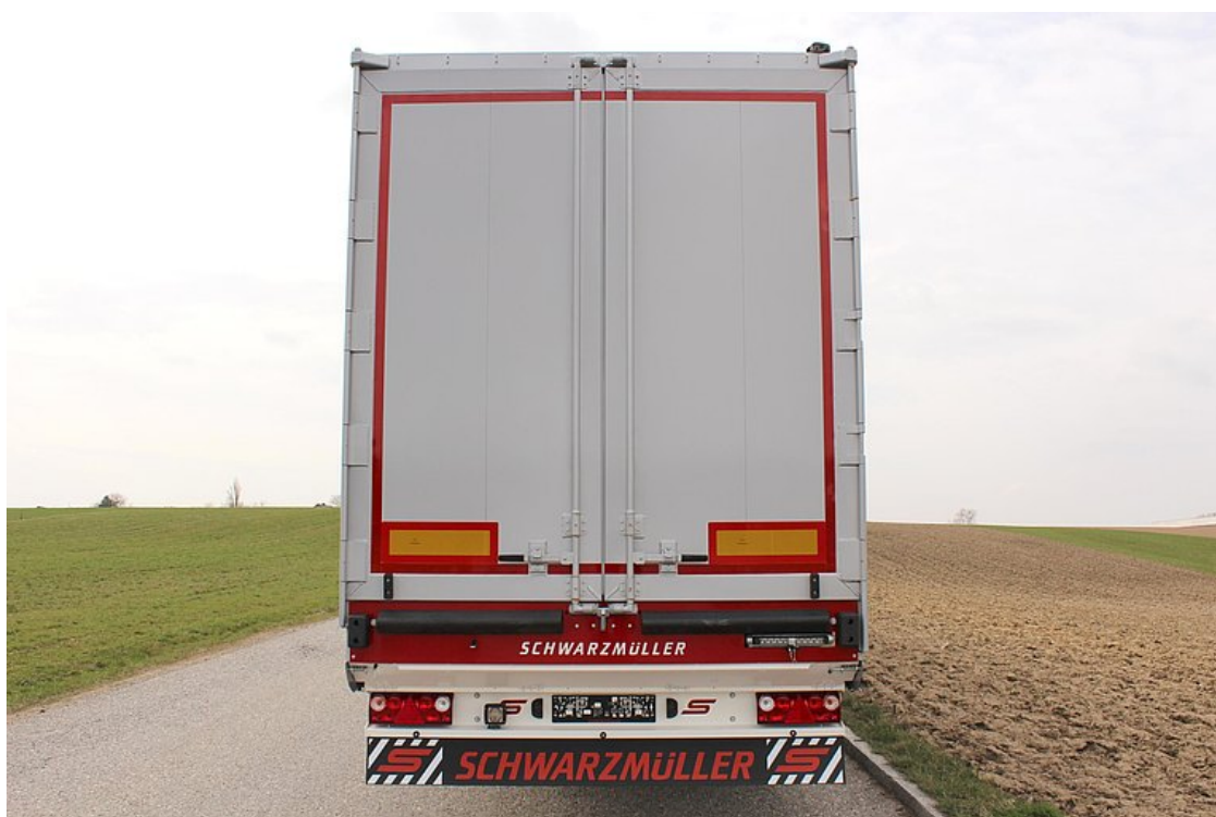
Tylna ściana = drzwi dwuskrzydłowe z leżącą na zewnątrz 1 zawrotnicą na każde skrzydło drzwi i dodatkowym zamkiem bezpieczeństwa, uruchamiane pneumatycznie
