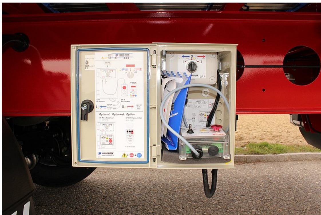
Panel sterowania w wodoszczelnej skrzynce oraz dodatkowo pilot zdalnego sterowania z kablem o długości 10 m
