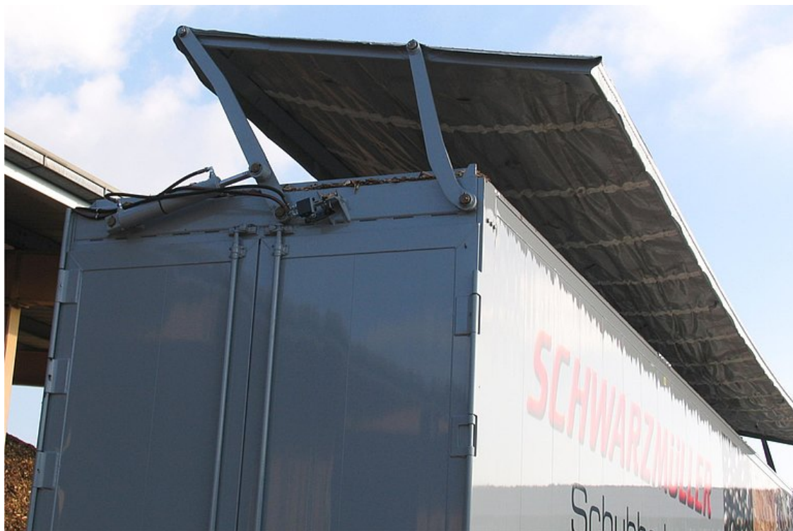
OPCJONALNIE: hydrauliczny dach nożycowy z ramą dachową dookoła i plandeką z tworzywa sztucznego
