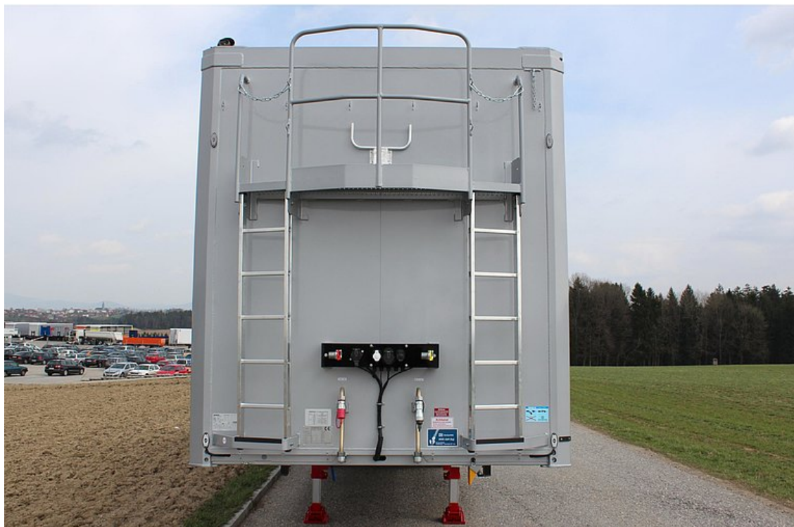
Stałą ścianą przednią z aluminiowych profili zamkniętych z górną ramą stabilizującą
