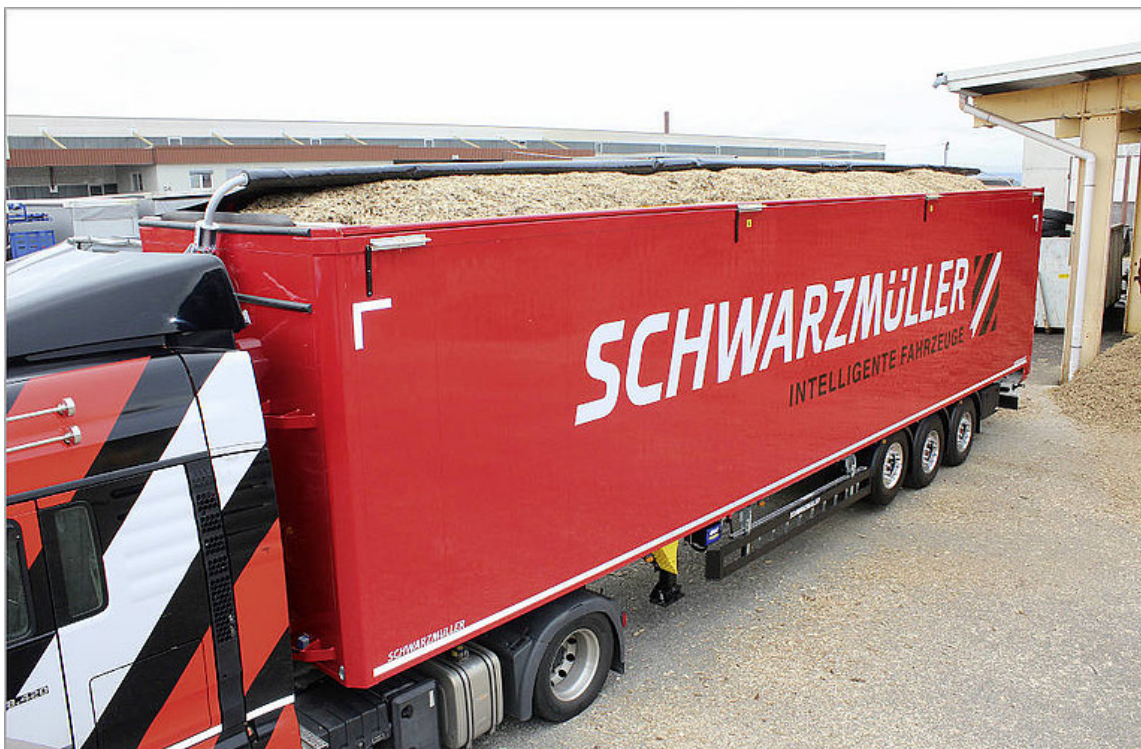
Naczepa 3-osiowa z ruchomą podłogą i ramą aluminiową opcjonalnie z elektrycznie zwijanym dachem
