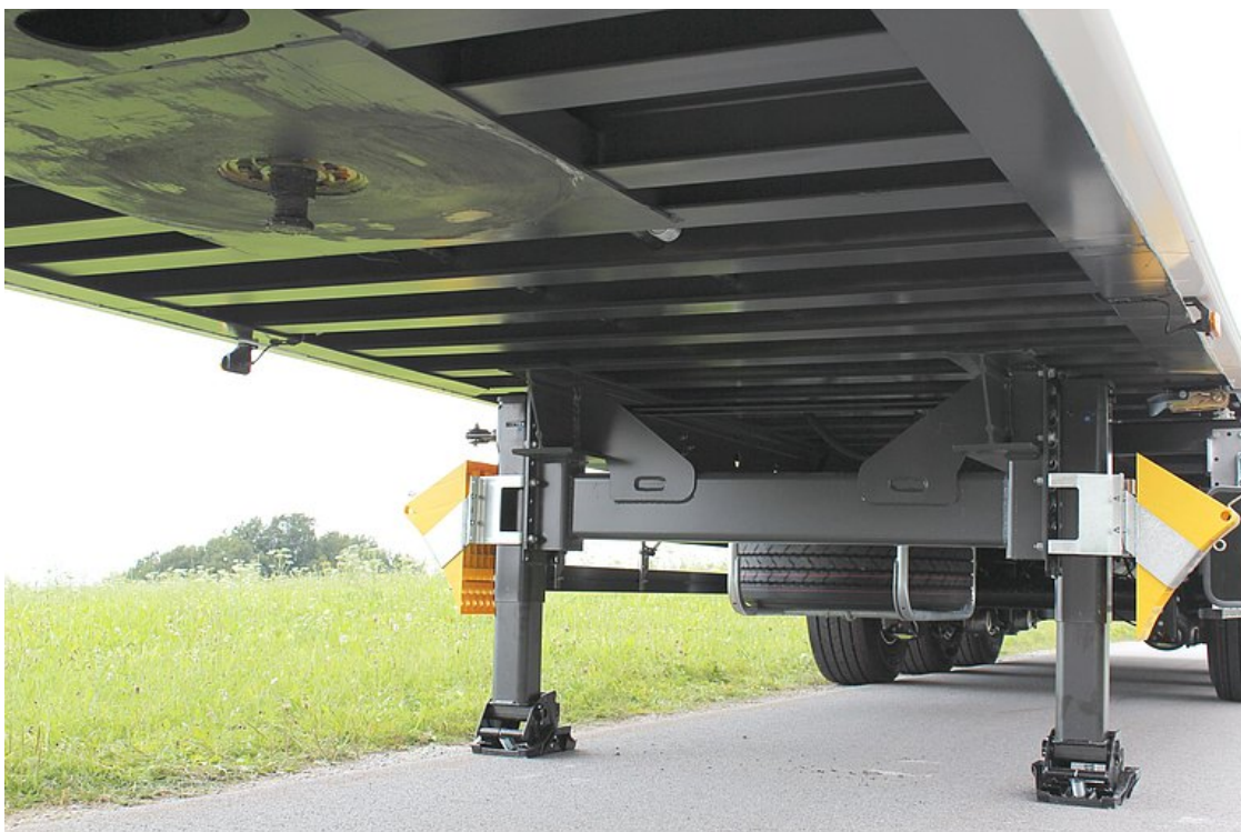
Aluminiowa lekka rama i dzięki temu większa ładowność aż o 500 kg
