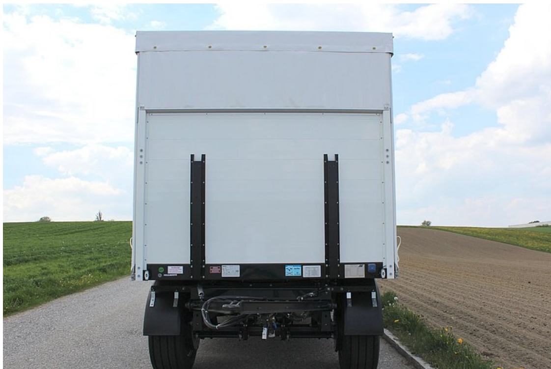
Wzmocniona ściana przednia z aluminiowych profili zamkniętych ze zintegrowanym uchwytem na sprzęt
