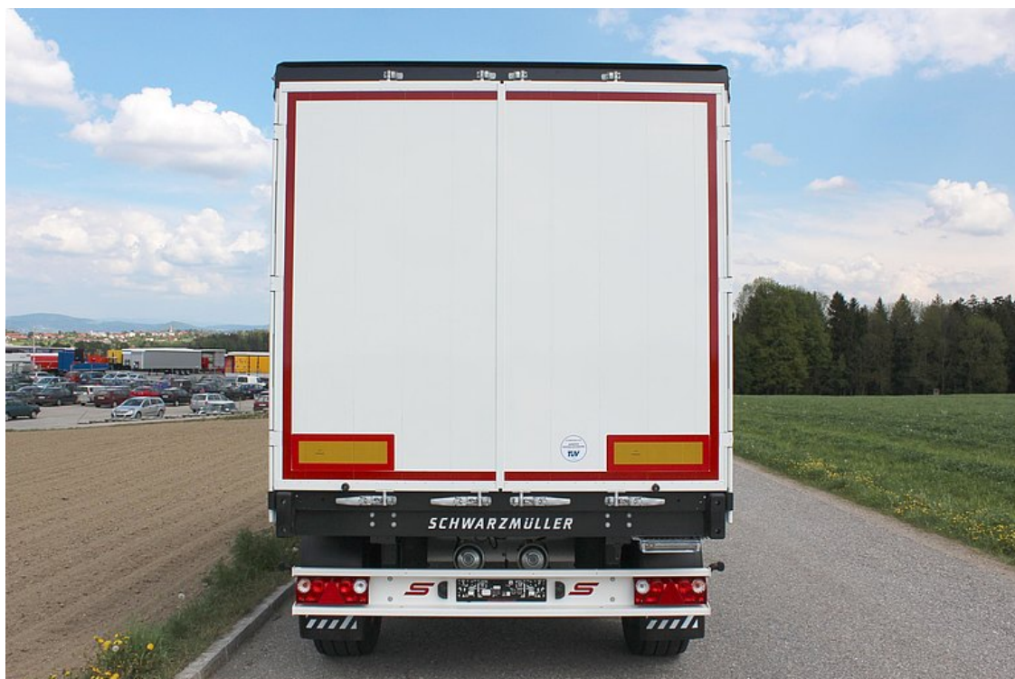
Z tyłu przykręcony portal z aluminiowymi słupkami narożnymi, w tym w pełni otwierane drzwi podwójne o konstrukcji profilowej
