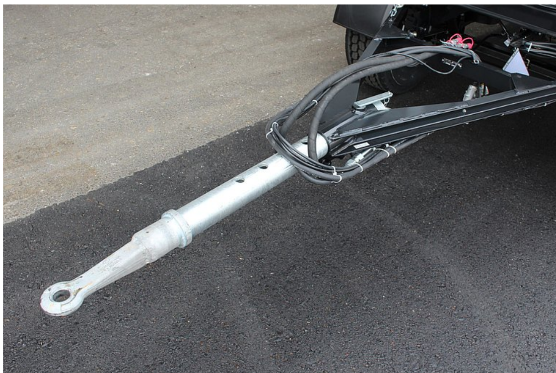
OPCJONALNIE: wyciągany dyszel przyczepy, regulowany o maks. 600 mm, z podporą dyszla Getofix
