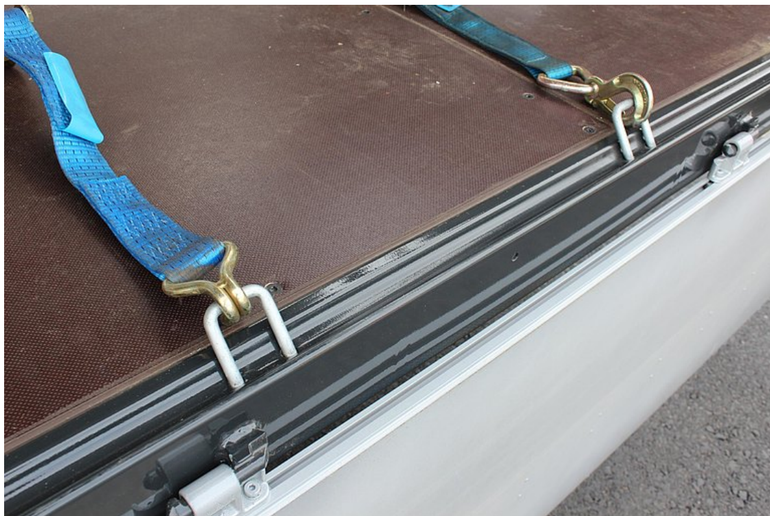
Rama zewnętrzna z 15 param wpuszczonych uchwytów mocujących 2,5 t do zabezpieczenia ładunku
