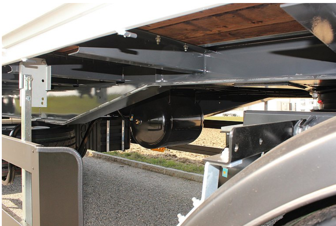
Wzmocniona konstrukcja ramy do obciążenia punktowego 14 t na 3 m w środku ciężkości
