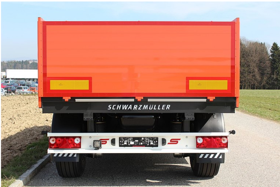
Składana tylna ściana z aluminiowych profili zamkniętych, obramowanie nitowane również od wewnątrz, składane z podwójną blokadą zamknięcia słupka firmy Kinnegripp
