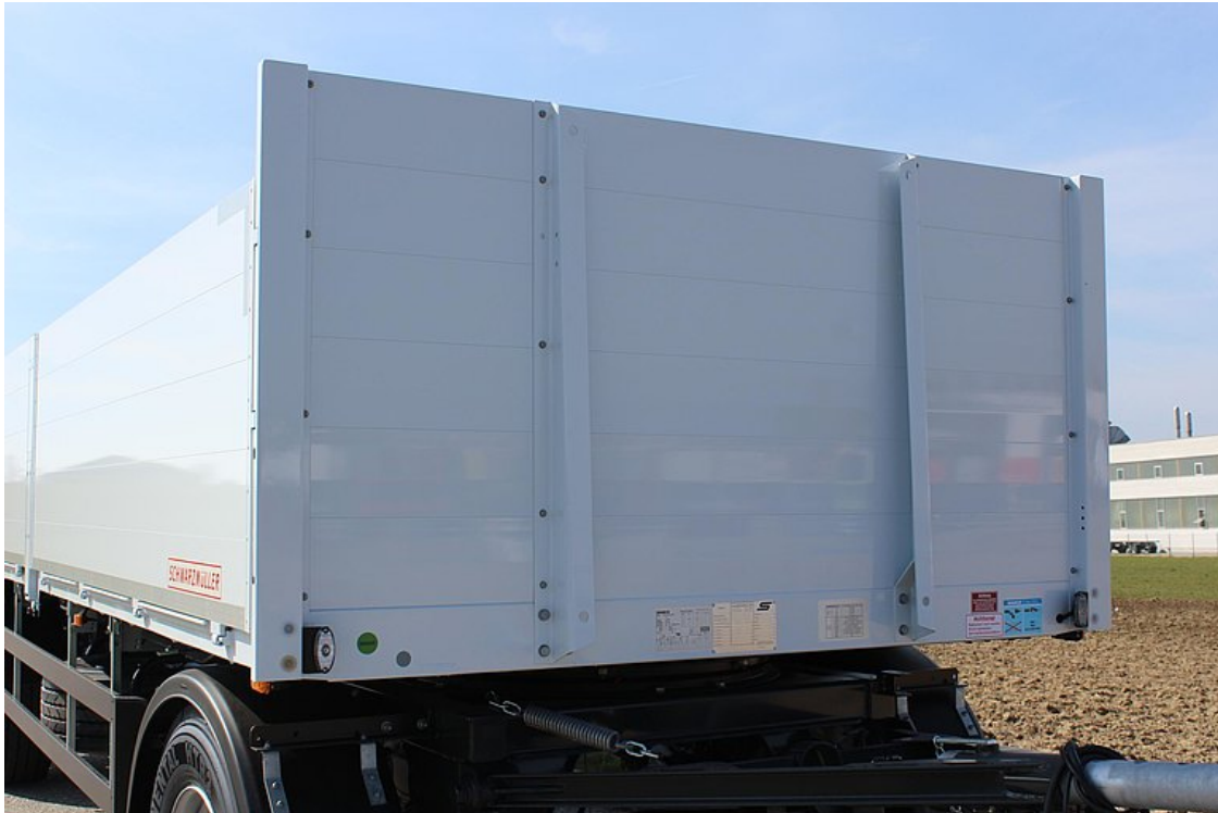
Stała ściana przednia z aluminiowych profili zamkniętych z 2 podporami środkowymi do samej góry
