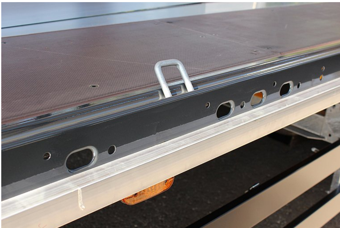
Rama zewnętrzna z otworami (zaczynając od ok. 3 000 mm od ściany przedniej) o rozstawie otworów ok. 100 mm, otwór podłużny 40/25 mm według DIN EN 12640 oraz dodatkowo 23 pary wpuszczonych uchwytów mocujących 2,5 t
