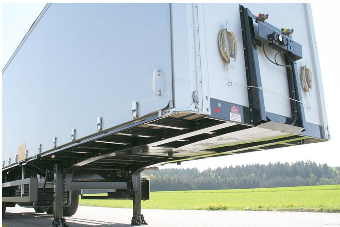
Odporna na skręcanie spawana konstrukcja ramy drabinowej
