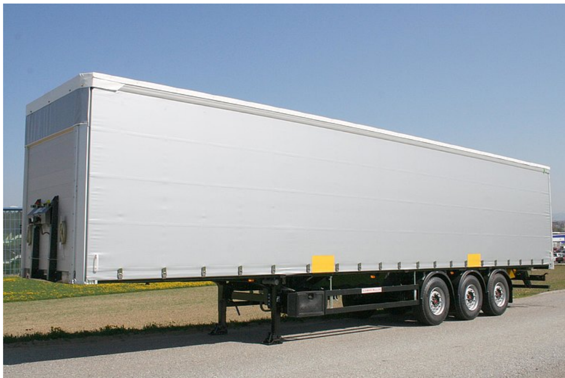
Wysokiej jakości aluminiowe elementy nadwozia o niskiej korozji, testowane zgodnie z normą EN 12642 XL
