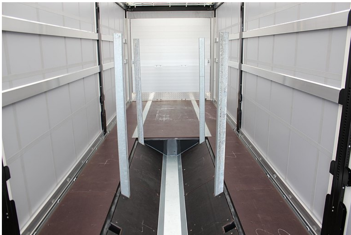
Wgłębienie na zwoje o długości użytkowej ok. 7 400 mm, z 5 parami zintegrowanych obudów wtykowych, do średnic zwojów do 2 100 mm
