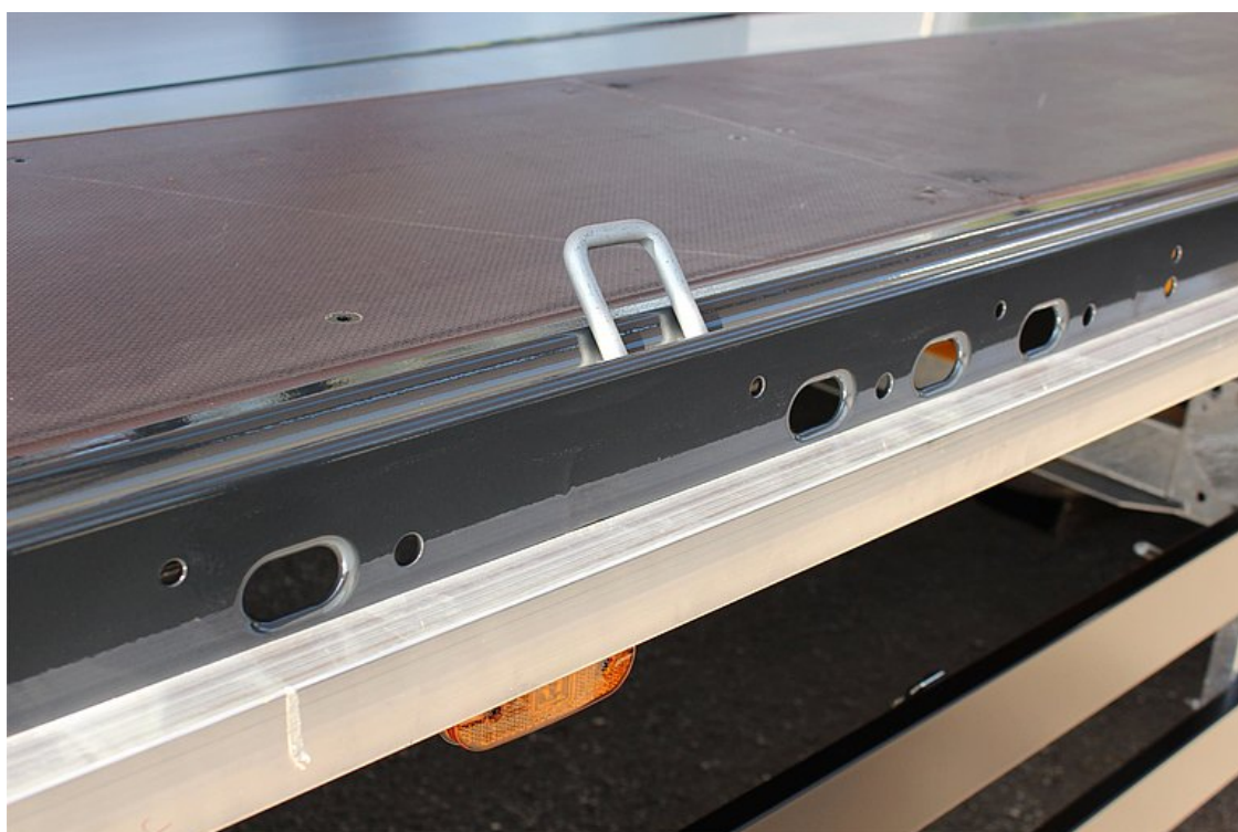
Rama zewnętrzna z otworami (zaczynając od ok. 3 000 mm od ściany czołowej) o rozstawie otworów ok. 100 mm, otwór podłużny 40/25 mm zgodnie z normą DIN EN 12640 i 21 par wpuszczonych uchwytów/ pierścieni mocujących 2,5 t, dodatkowo 5 par uchwytów mocujących 4 t w pobliżu wgłębienia na ramie zewnętrznej
