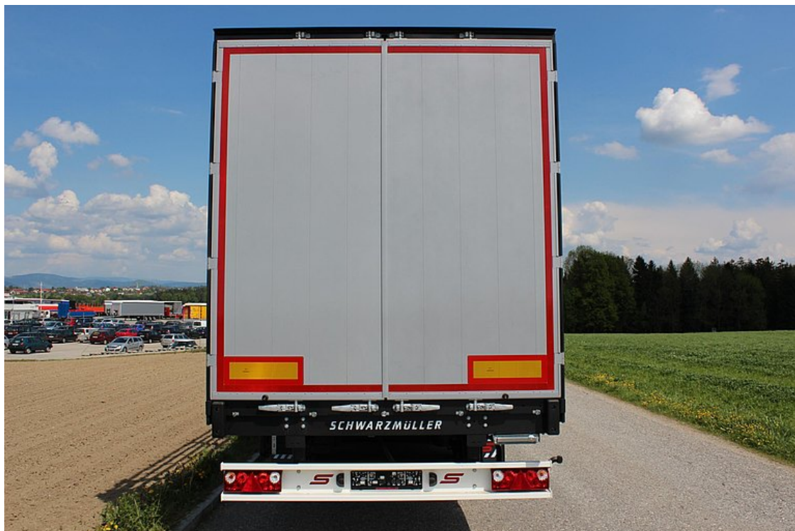
OPCJONALNIE: rama portalu z podwójnymi drzwiami - z tyłu portal przykręcany wraz z w p
