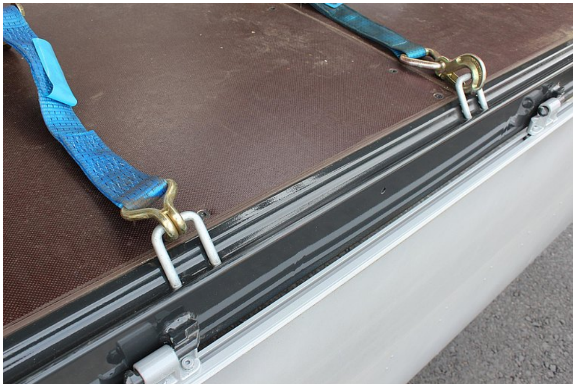
Rama zewnętrzna z 23 parami uchwytów mocujących 2,5 t do zabezpieczania ładunku
