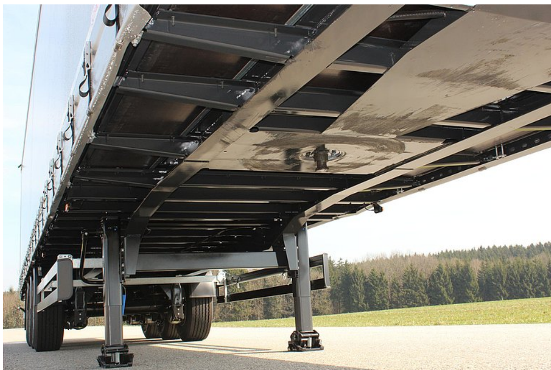
Odporna na skręcanie spawana konstrukcja ramy drabinowej
