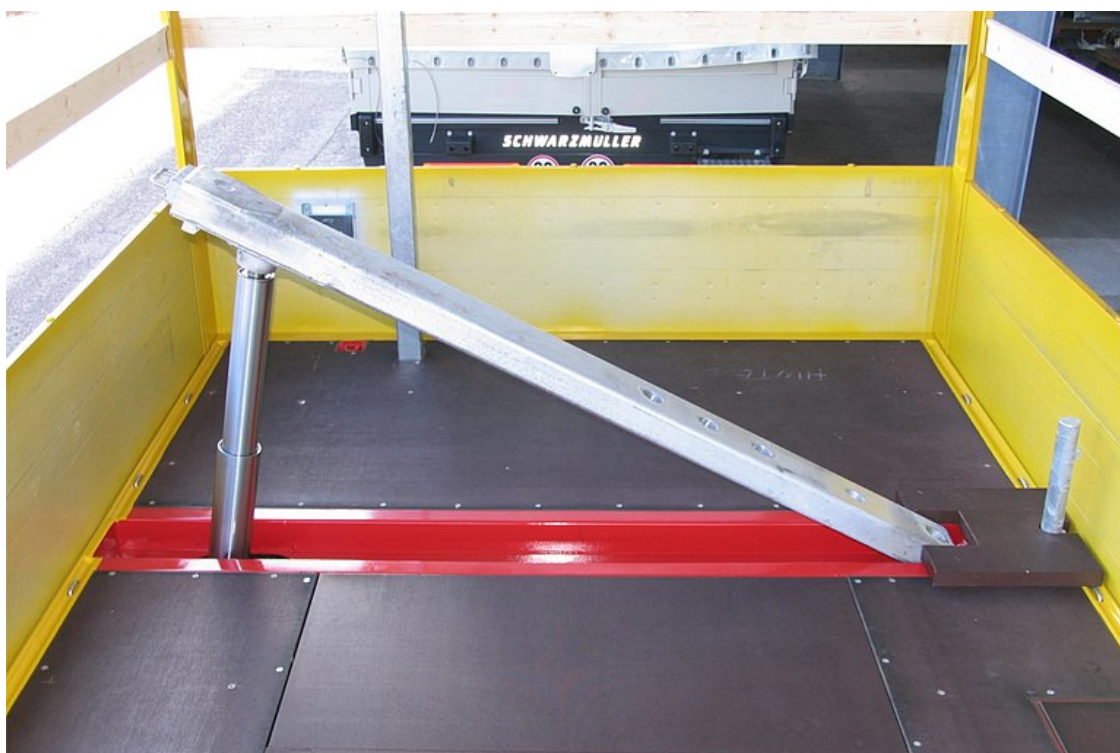
Zamontowane jako wpuszczone wsporniki z rury kształtowej, wysuwane hydraulicznym 4-stopniowym siłownikiem podnoszącym
