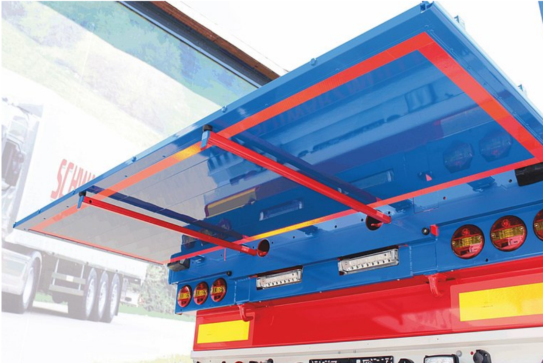
OPCJONALNIE: 2 podpory wysuwane jako podpora tylnej ściany (nie można obciążać)
