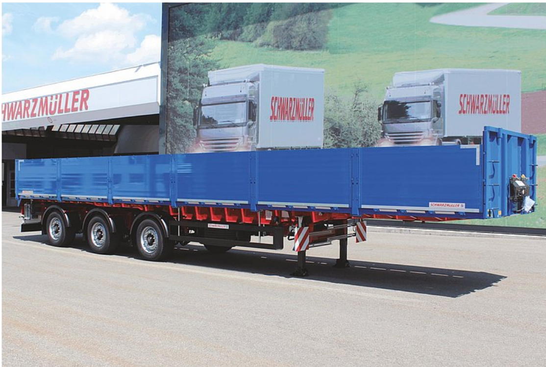
3-osiowa naczepa siodłowa płaska z/na żuraw rolkowy
