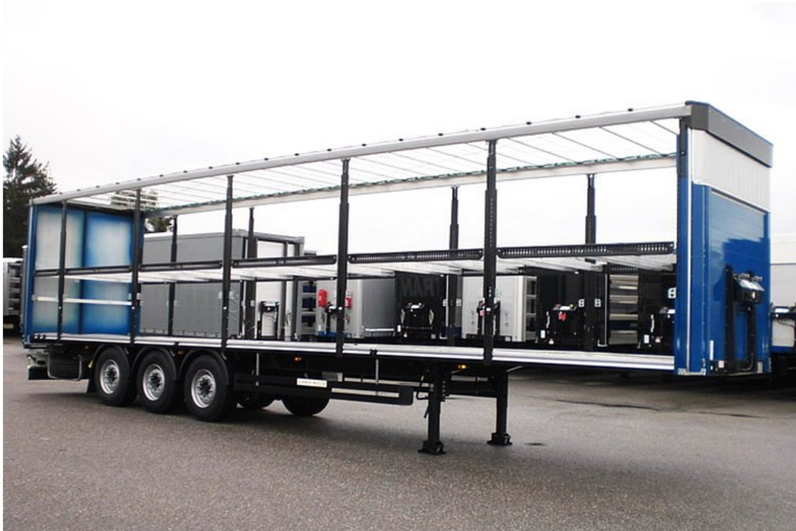
3-osiowa naczepa siodłowa płaska kurtynowa z urządzeniem do załadunku dwupoziomowego
