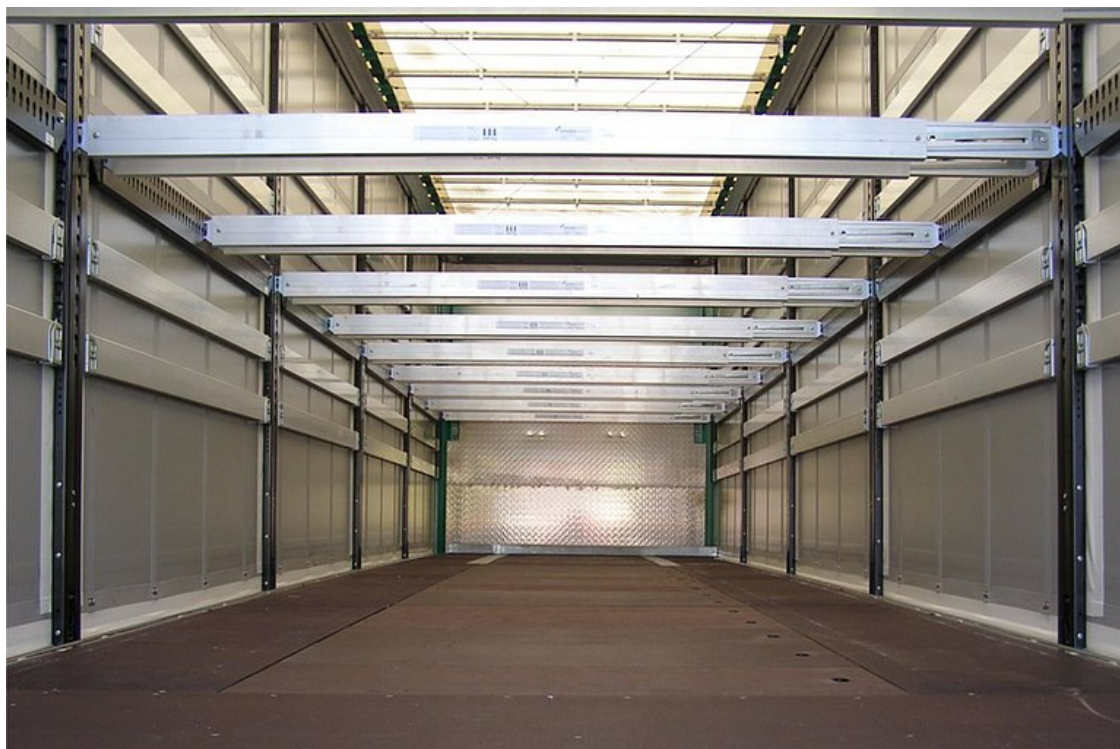
OPCJONALNIE: dwupoziomowe urządzenie załadownicze CTD III do 11 x 3 europalet, udźwig 400 kg/paleta
