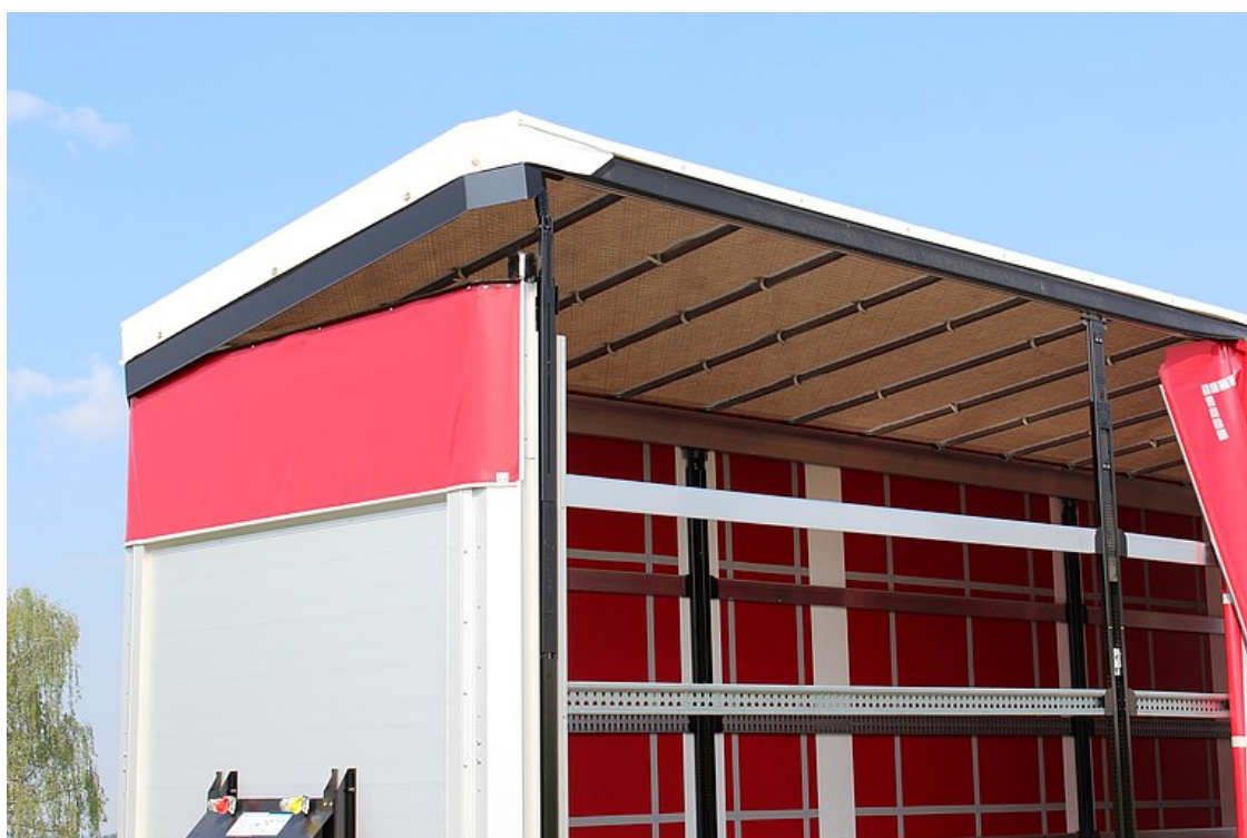
OPCJONALNIE: ręczny, hydrauliczny dach podnoszony można podnieść o 400 mm w celu szybkiego załadunku i rozładunku
