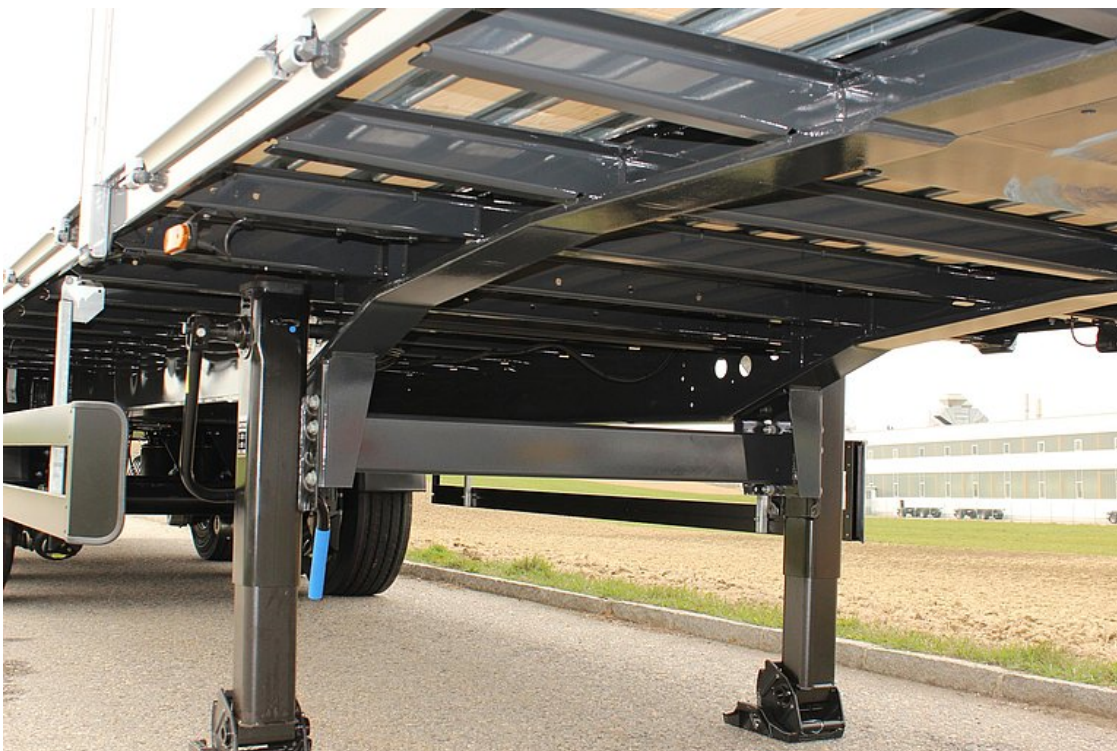
Wzmocniona konstrukcja ramy dla obciążenia punktowego 20 t na 4 m w środku ciężkości
