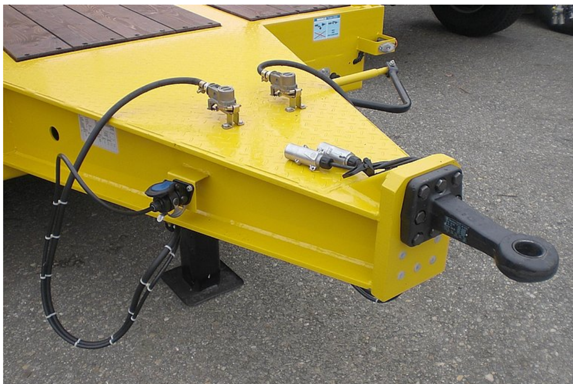
Urządzenie ciąglowe ściągnięte przed platformą pomostu, z przykręconym uchem dyszla
