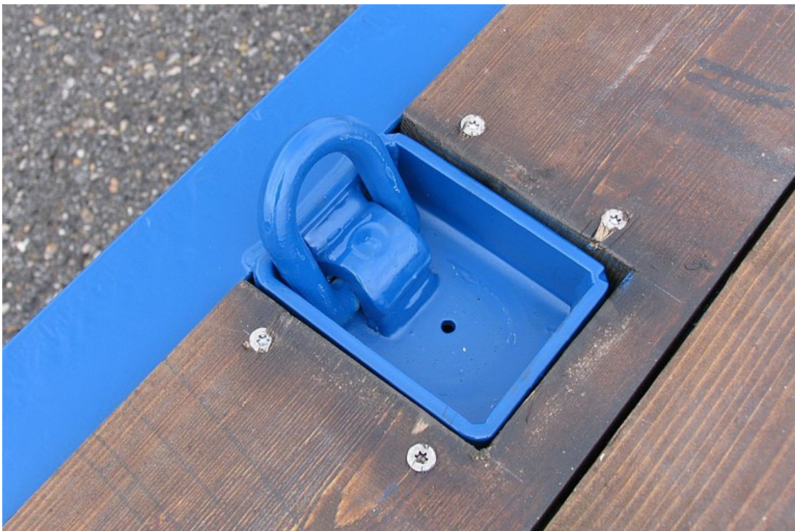
Wpuszczone w podłogę pierścienie mocujące oraz uchwyty mocujące na ramie zewnętrznej do optymalnego zabezpieczenia ładunku
