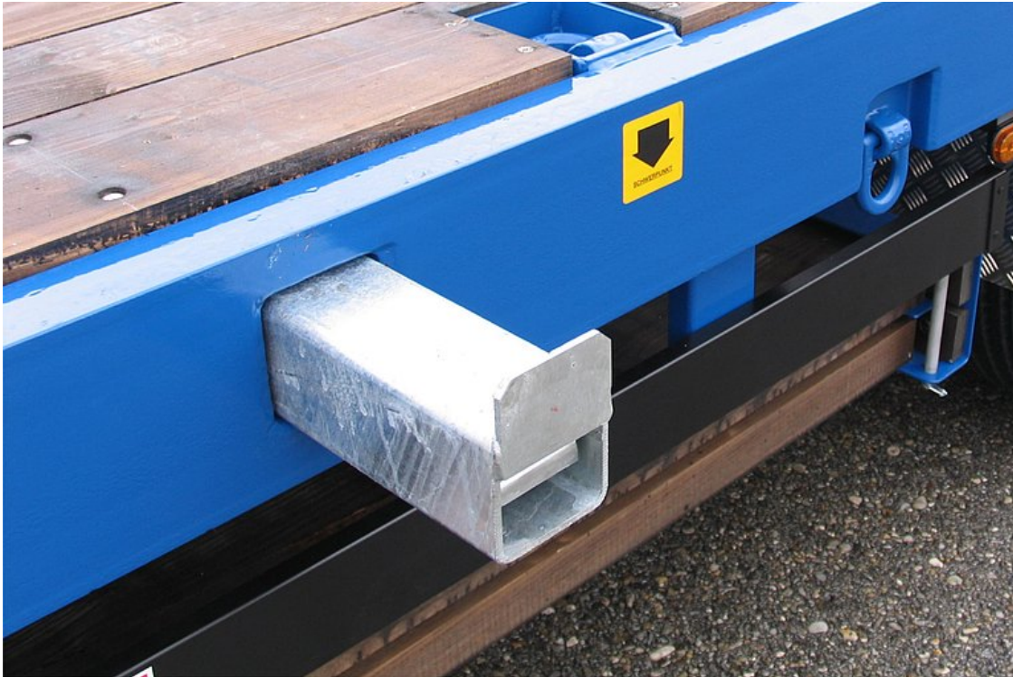
Wyciągane poszerzenia wraz z belkami poszerzającymi do transportów ponadgabarytowych
