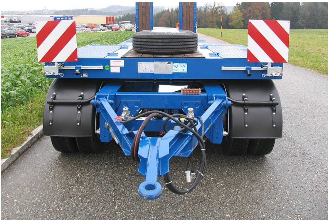
Z przodu platforma załamana ze schowkami na akcesoria i wyciąganymi tablicami ostrzegawczymi do transportów ponadgabarytowych
