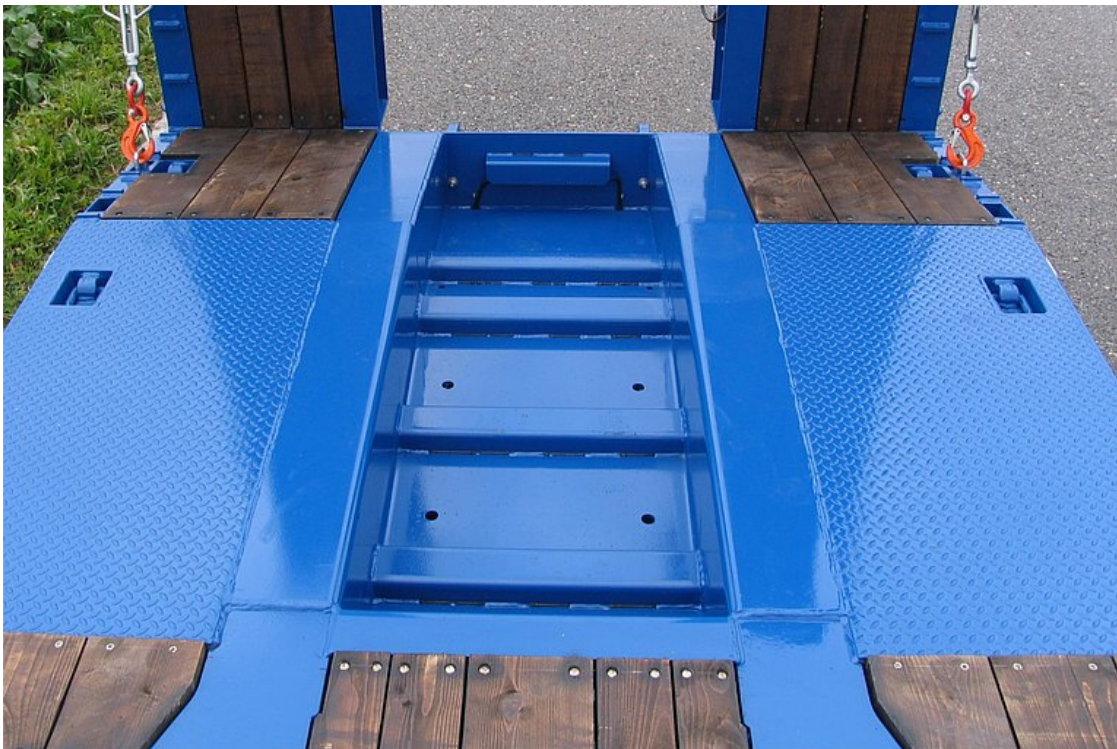
Zagłębienie na łyżkę koparki - zagłębienie między podłużnicami
