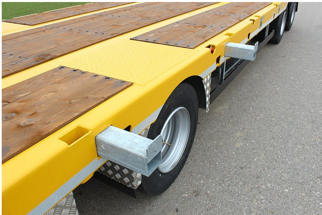
Wyciągane poszerzenia, po obu stronach na niskim podwoziu i na tylnym skosie, wraz z belkami poszerzającymi do transportów ponadgabarytowych
