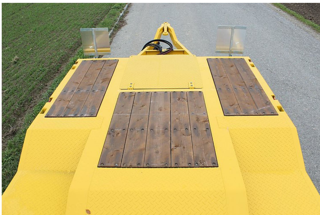
Z przodu platforma podniesiona z załamaniem ramy, narożniki ścięte
