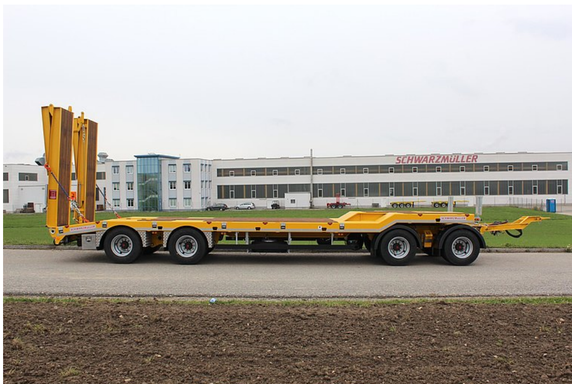
4-osiowa przyczepa niskopodwoziowa z platformą załamaną
