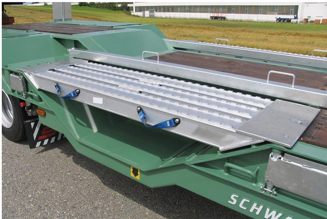
Zagłębienia na koła w ramie zewnętrznej, pasujące do konstrukcji podłogi wraz z aluminiową osłoną, po której można jeździć
