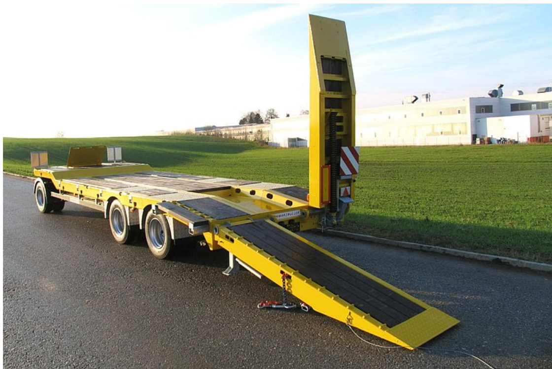
2 składane 1-częściowe rampy najazdowe z pokryciem z twardego drewna
