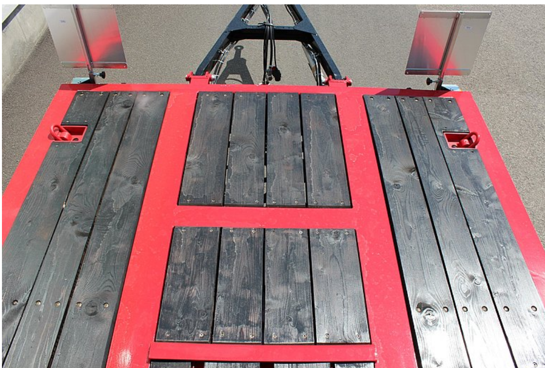
Impregnowana podłoga z miękkiego drewna wystająca ponad profile ramy
