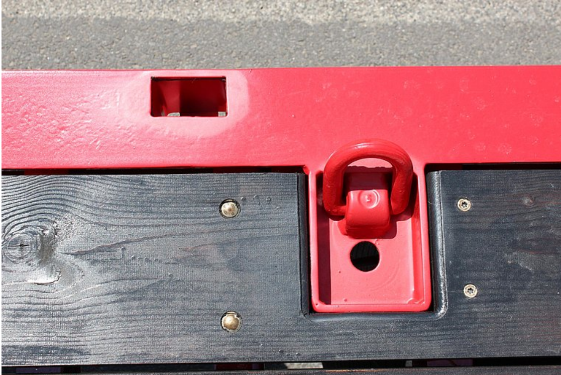
5 par wpuszczonych składanych pierścieni mocujących
