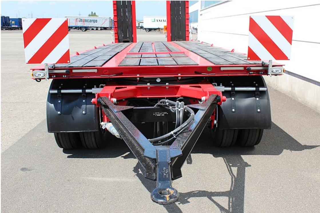
Z przodu wózek skrętny z dyszlem i wysuwanymi tablicami ostrzegawczymi do transportu ponadgabarytowego na ramie
