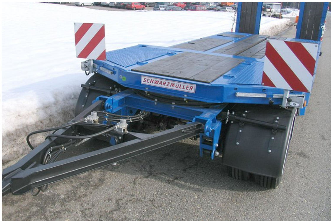
Przedni wózek jezdny z dyszem - OPCJONALNIE: wysuwane tablice ostrzegawcze do transportu ponadgabarytowego z przekroczeniem szerokości
