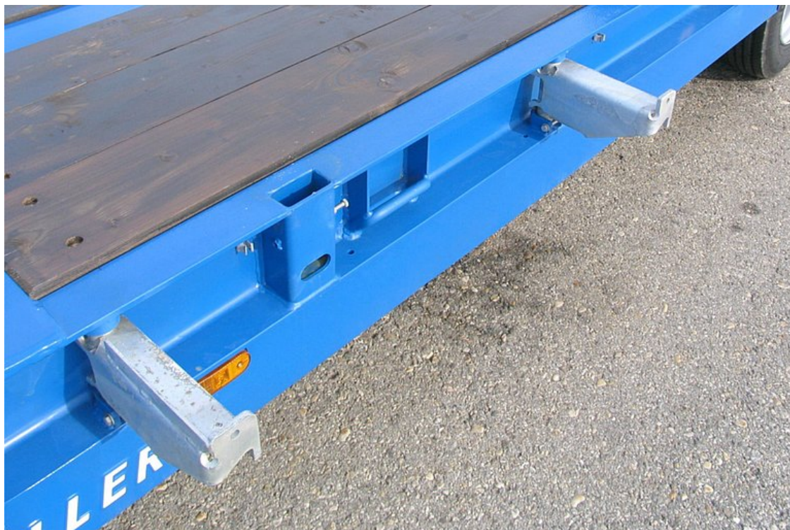
OPCJONALNIE: składane, obrotowe poszerzenia, w tym belki poszerzające do transportu ponadgabarytowego
