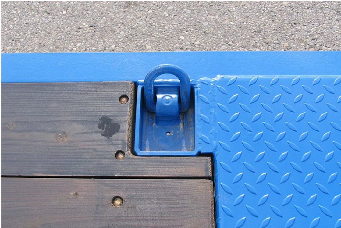
2 pary zagłębionych składanych pierścieni mocujących na platformie
