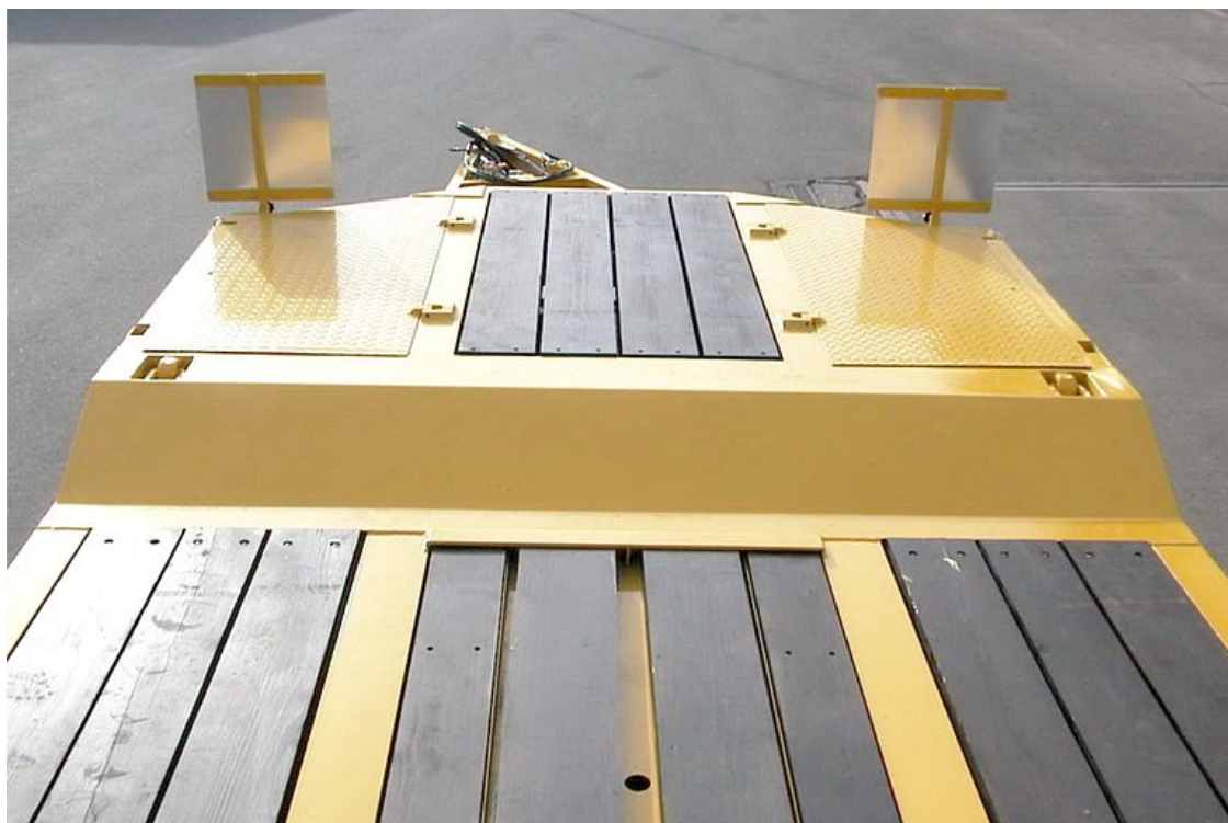
Przednia platforma załamaną z półkami na akcesoria - OPCJONALNIE: półki na akcesoria z pokrywą i wysuwanymi tablicami ostrzegawczymi do transportu ponadgabarytowego z przekroczeniem szerokości
