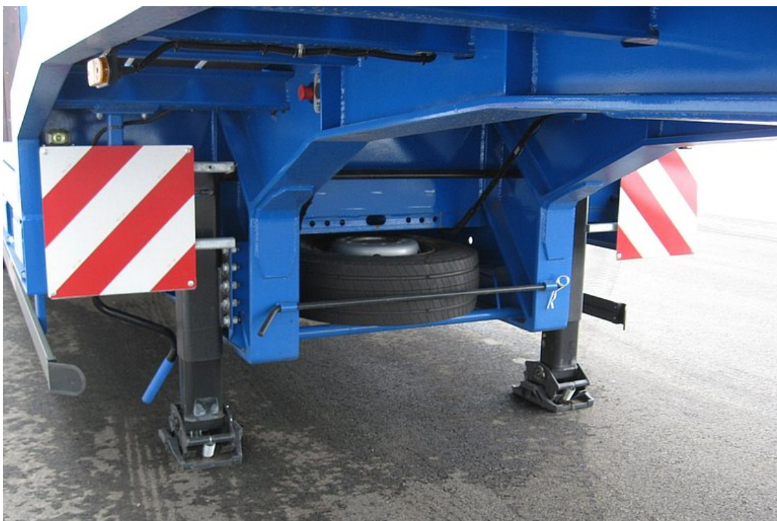
Stalowa konstrukcja spawana - duże obciążenie punktowe ze względu na wąski odstęp między belkami poprzecznymi
