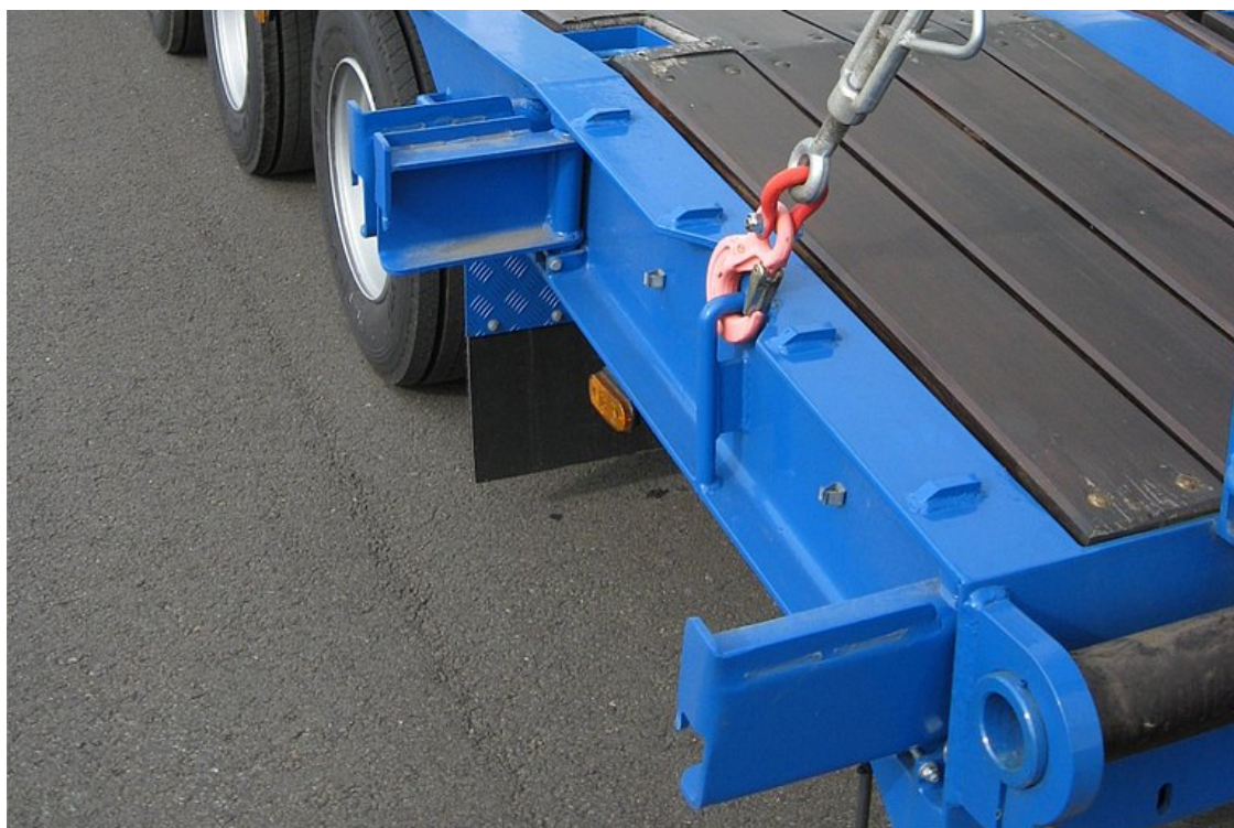
Składane, odchylane poszerzenia wraz z belkami poszerzającymi do transportów ponadgabarytowych
