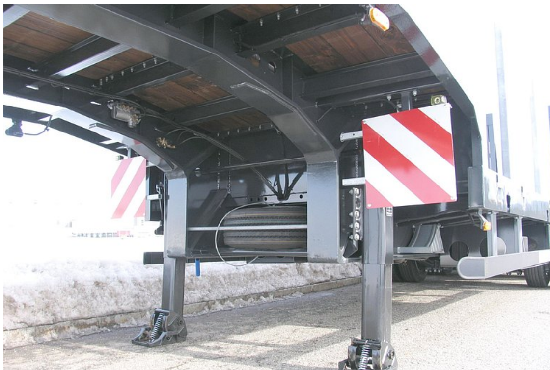
Wzmocniona i odporna na skręcanie stalowa konstrukcja spawana z wąskim odstępem między belkami poprzecznymi dla dużych obciążeń punktowych
