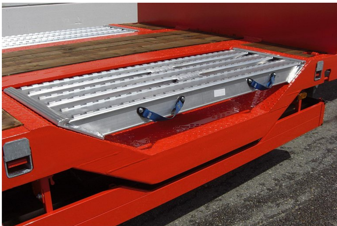
OPCJONALNIE: zagłębienia na koła - zagłębienia do transportu pojazdów specjalnych
