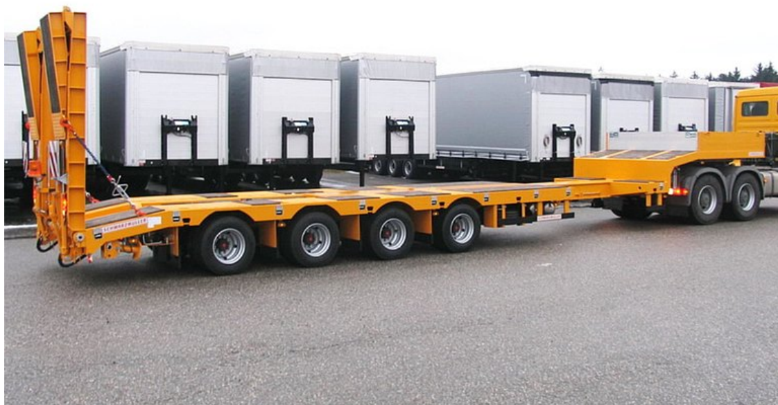
4-osiowa naczepa siodłowa niskopodwoziowa, wersja wzmocniona, rozciągana
