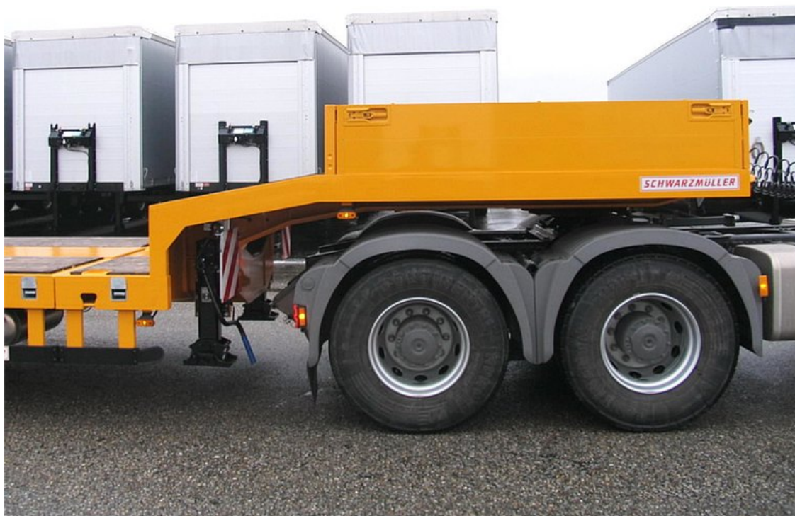
Z przodu podwyższona platforma załamana z wtykanymi burtami
