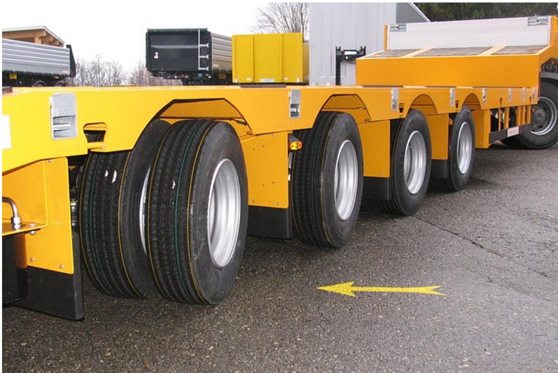
Trzecia i czwarta oś z samośledzącym układem kierowniczym dla lepszego pokonywania zakrętów i mniejszego zużycia opon
