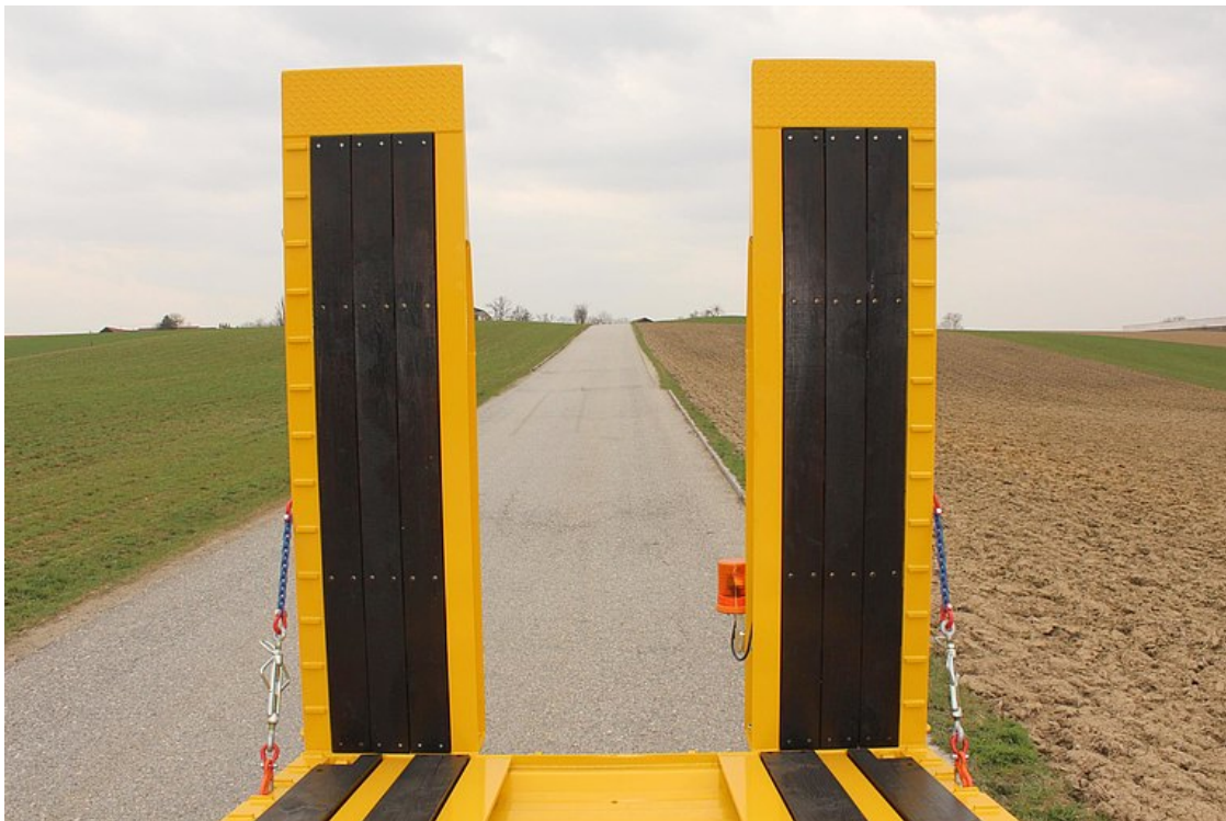
Rampy najazdowe z pokryciem z twardego drewna i naspawanymi kwadratowymi żebrami
