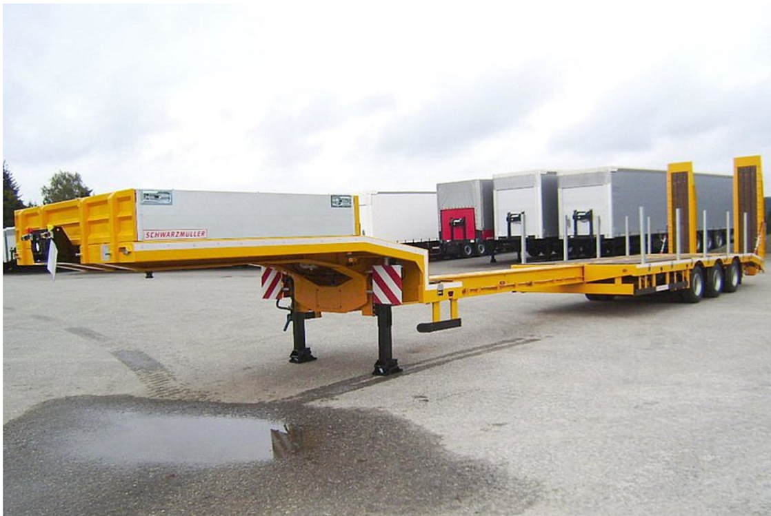
3-osiowa naczepa siodłowa niskopodwoziowa z platformą załamaną, wersja wzmocniona, rozciągana
