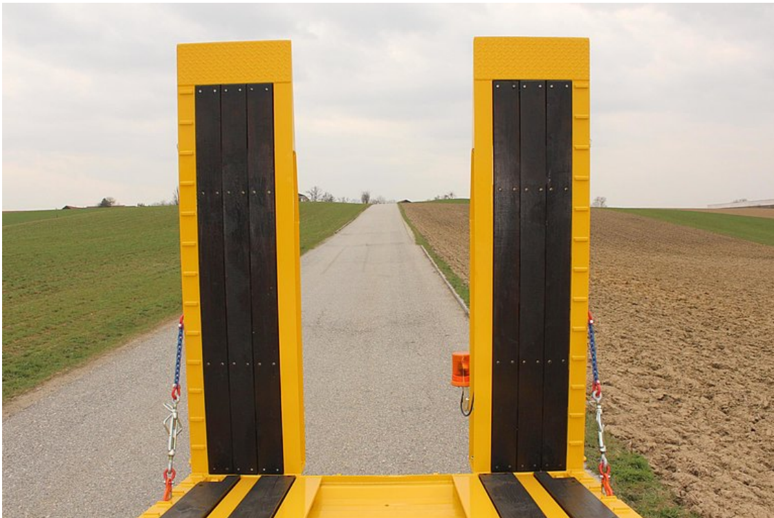
Rampy najzdowe z pokryciem z twardego drewna i naspawanymi kwadratowymi żebrami
