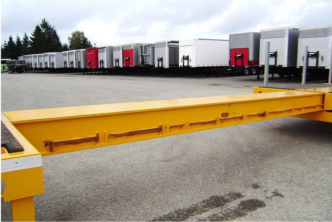
Rozciągnięta rama centralna, regulowana stopniowo z blokadą pneumatyczną
