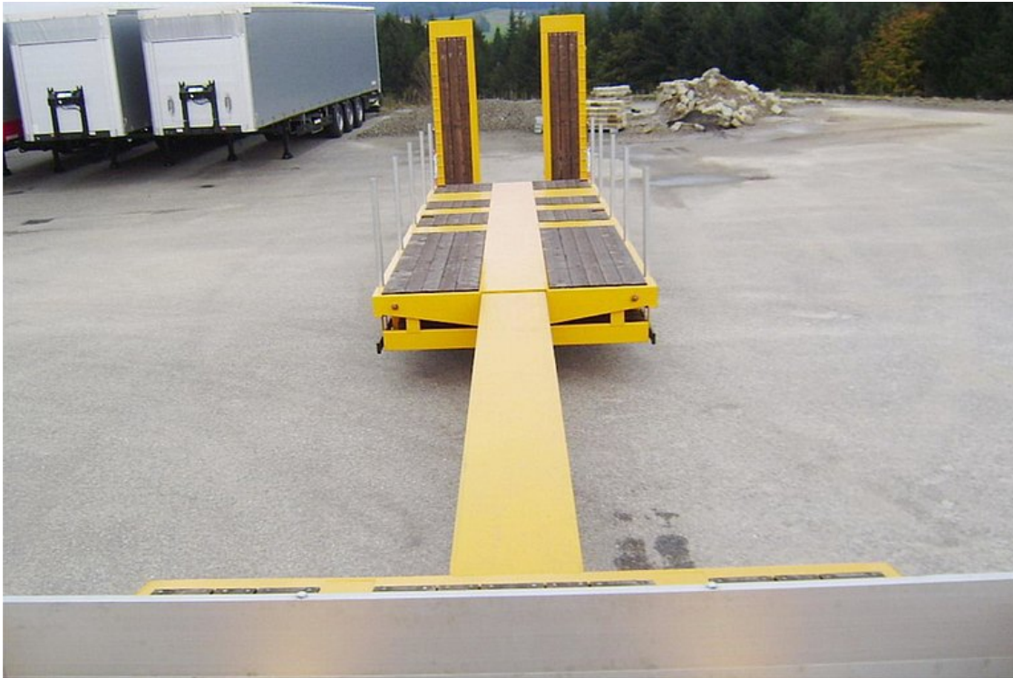
Powierzchnia ładunkowa niskiego podwozia z podłogą z miękkiego drewna wraz z kłonicami z rur kształtowych w ramie zewnętrznej
