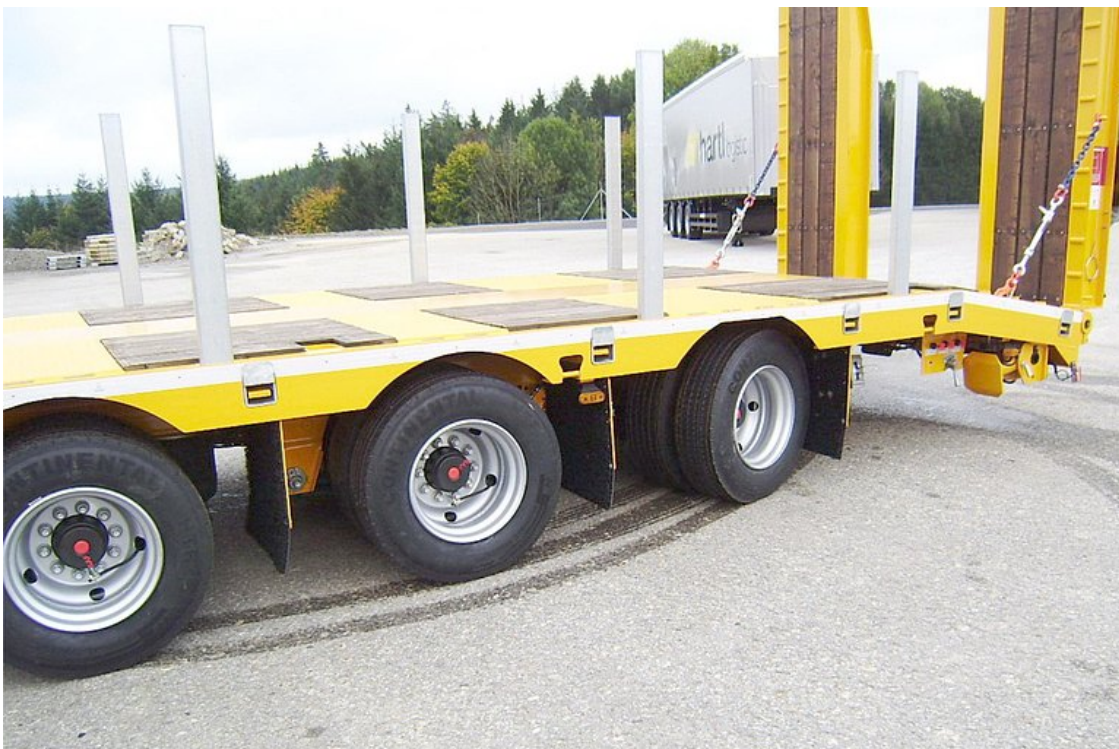
Trzecia oś wleczona zapewnia lepsze pokonywanie zakrętów i mniejsze zużycie opon
