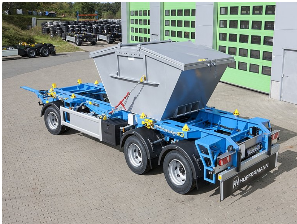
Vario-Carrier do transportowania kontenera bramowego w środku ciężkości obciążenia użytkowego
