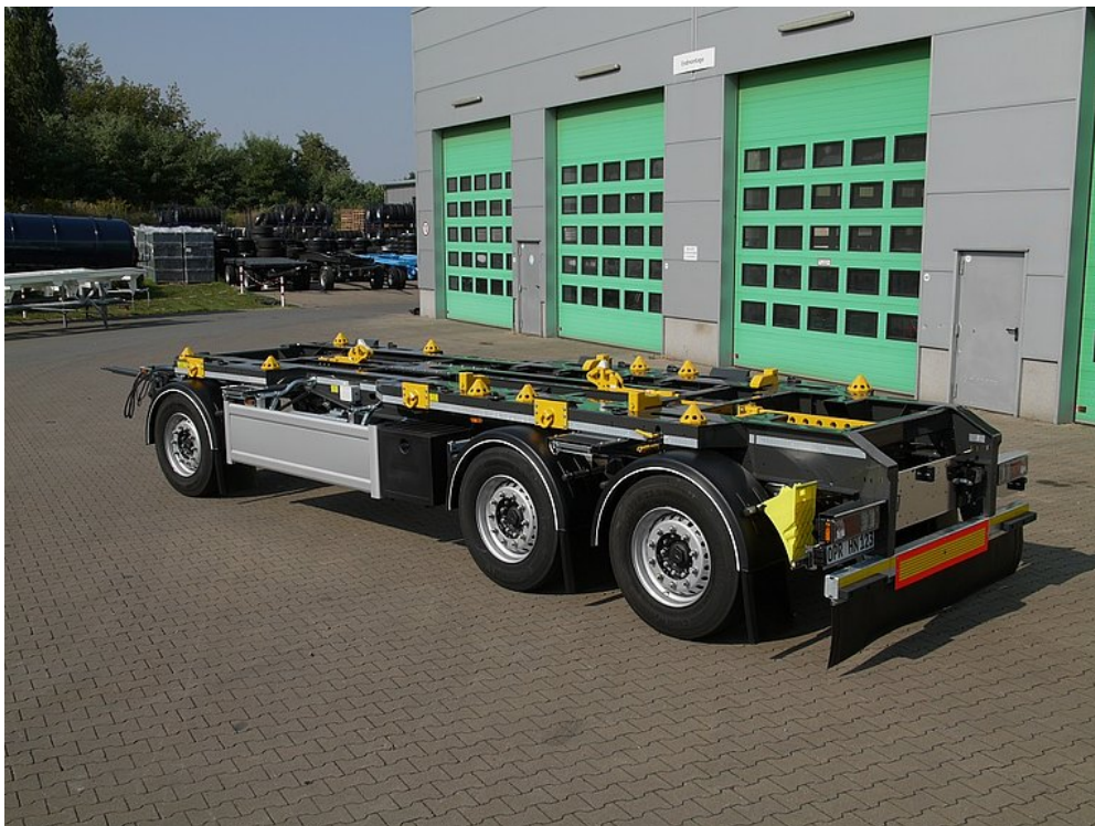
Wyposażenie specjalne w Multi-Fix regulowany – prasy do odpadów, TailGUARD
