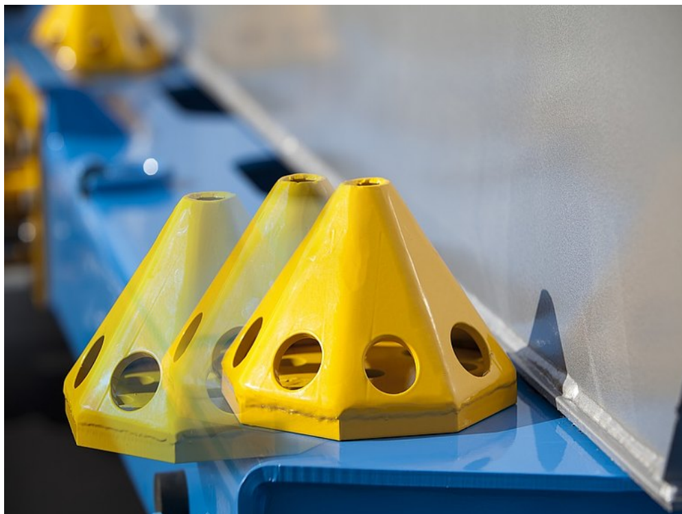
Zabezpieczenie ładunku zapewniające utrzymanie kontenera w optymalnej pozycji za pomocą Zentrier-Fix z 8 stopniami regulacji
