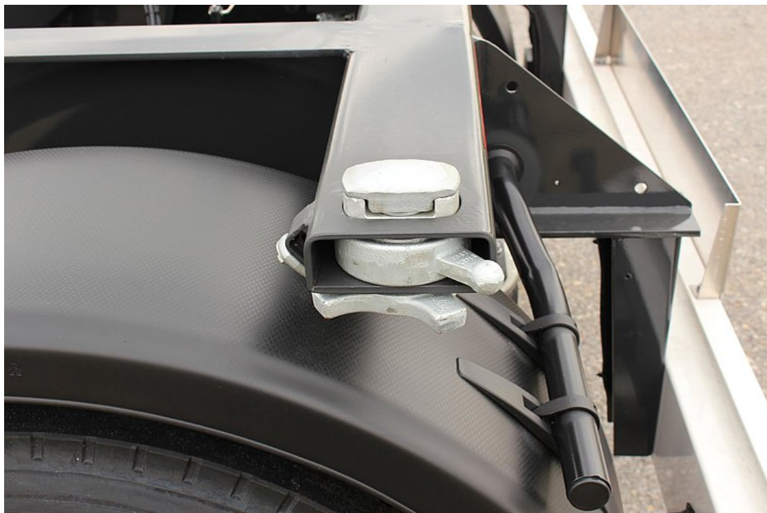
Belka podpierająca z 4 zamkami do kontenerów zgodnie z normą EN 284 (rozmiar zamknięcia 20 stóp)
