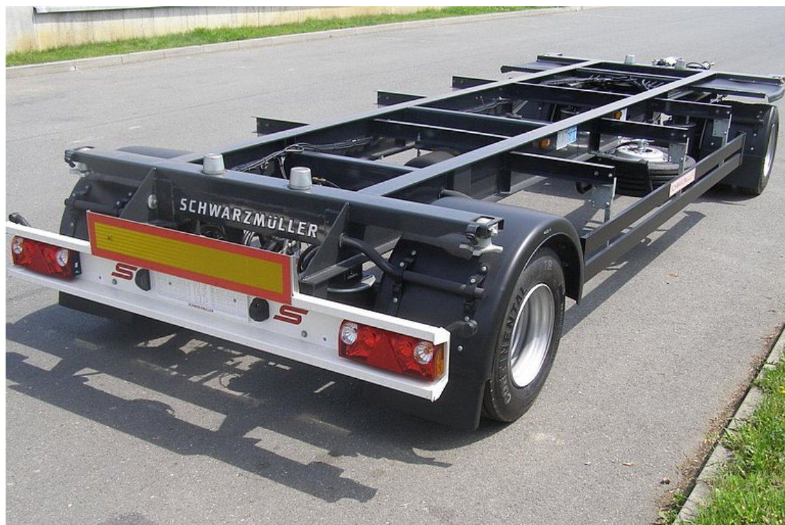
2-osiowe podwozie przyczepy niskopodwoziowej BDF
