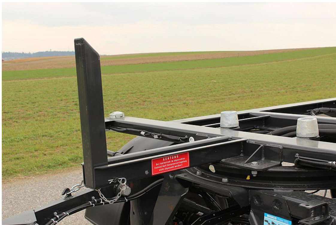
Wspornik oporowy z przodu można przekładać i przestawiać
