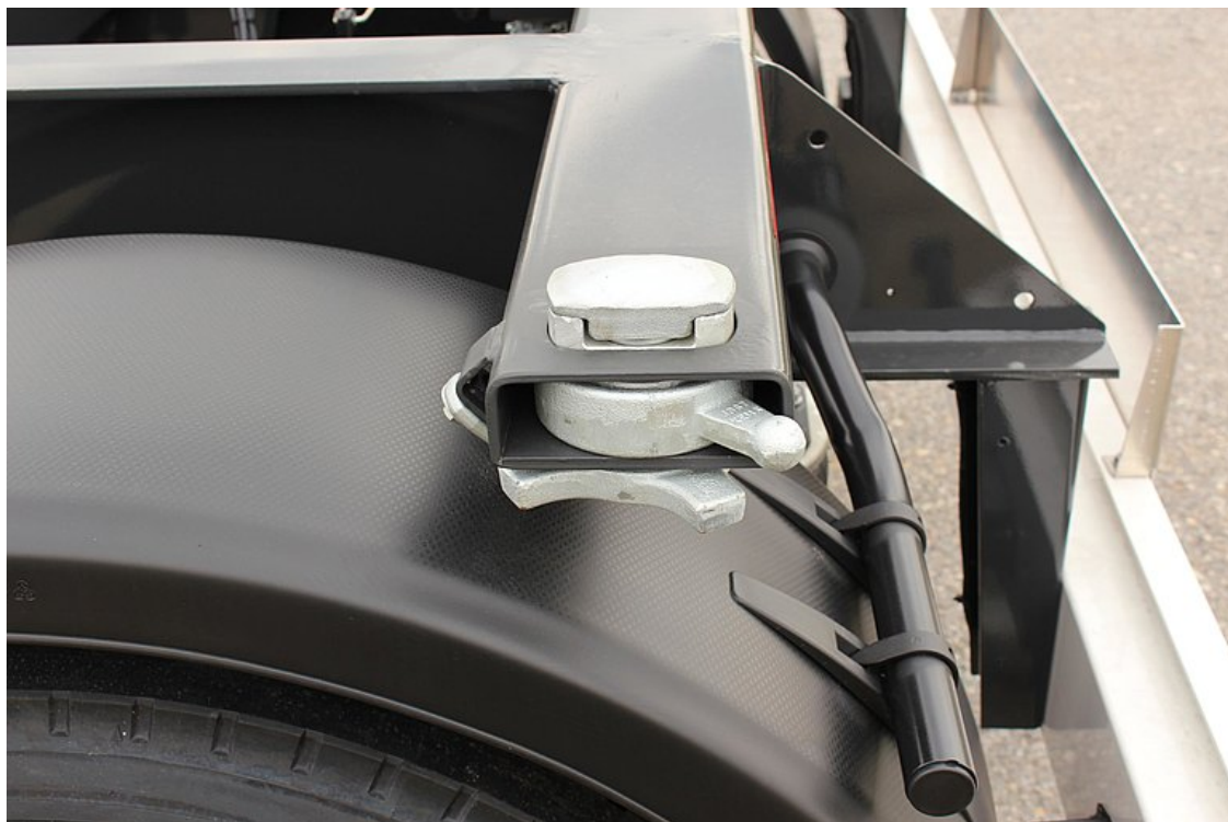
Belka poprzeczna podpierająca z zamkami do kontenerów zgodnie z normą EN 284
