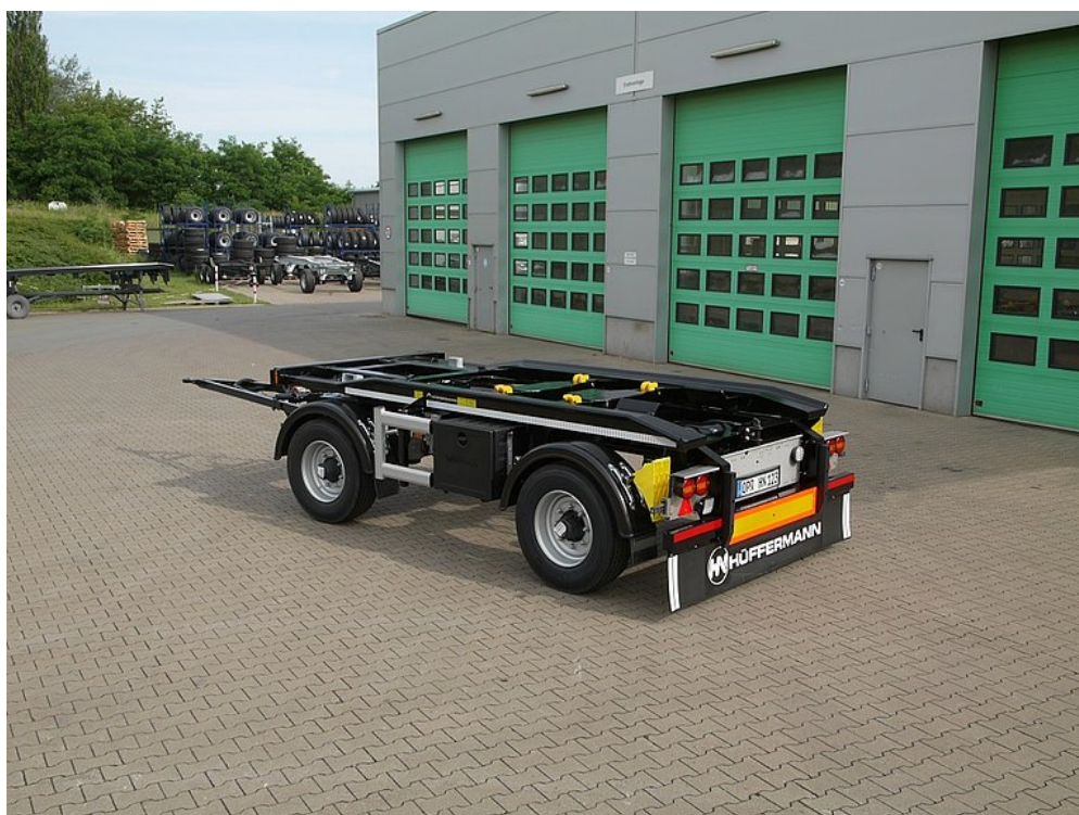
Wykonanie specjalne przystosowane do kontenerów miejskich zGG 12 t
