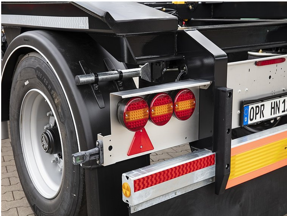
OPCJA WYPOSAŻENIA: 3 okrągłe lampy LED
