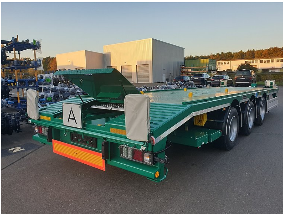
Wyposażenie specjalne ze schowkami na kłonicie i tablicami ostrzegawczymi o ponadnormatywnej szerokości
