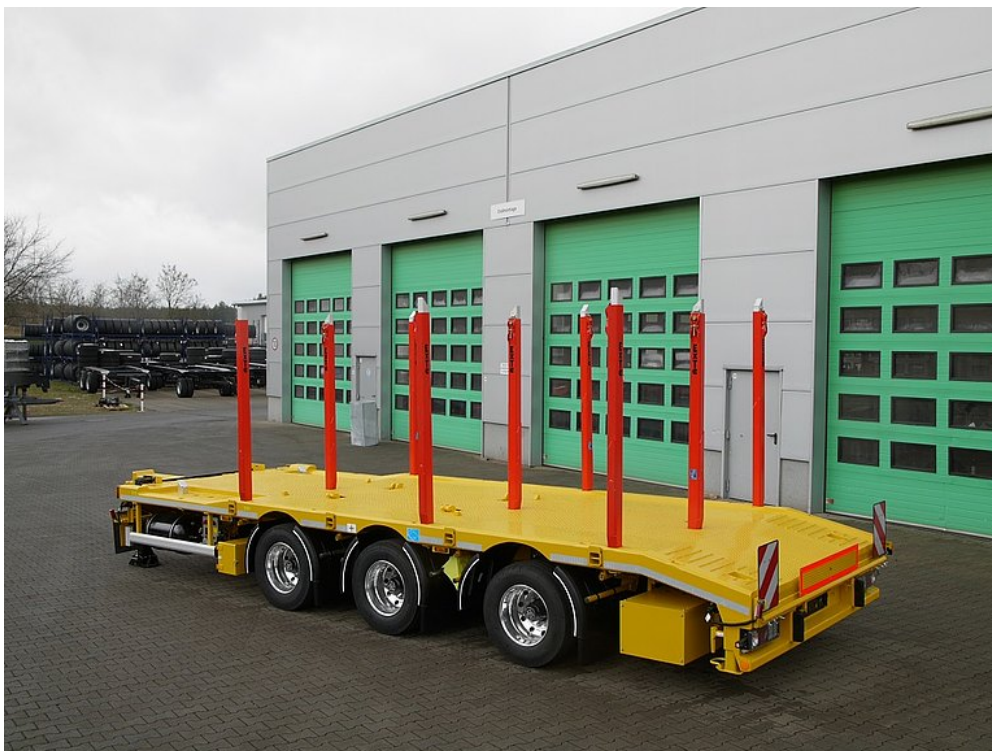
Wyposażenie specjalne z kłonicami EXTE, osią skrętną nadążną i aluminiowymi obręczami
