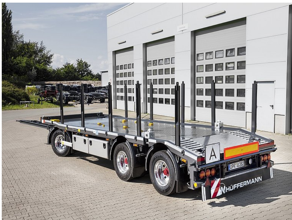
Wyposażenie specjalne w uchwyt kontenera ISO, kłonicę, aluminiowe koła i 3 okrągłe lampy LED
