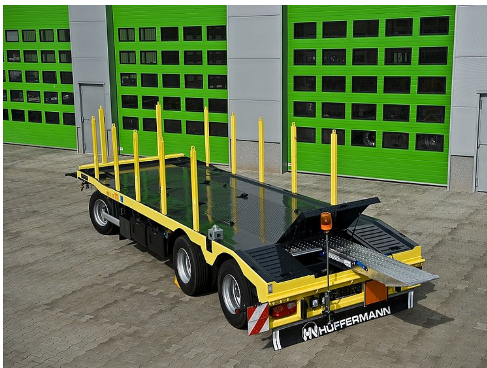
Wyposażenie specjalne w uchwyt kontenera ISO i kłonicę, lakierowanie specjalne
