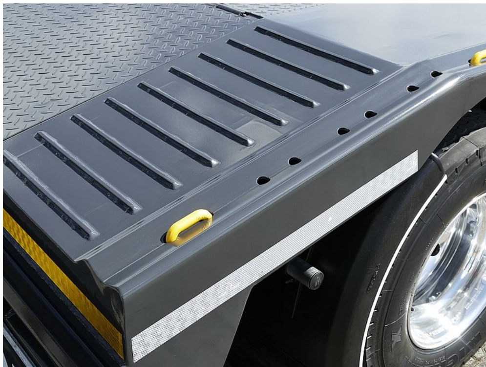
Opuszczane punkty mocowania z możliwością przykręcania w różnych miejscach na zewnętrznej ramie
