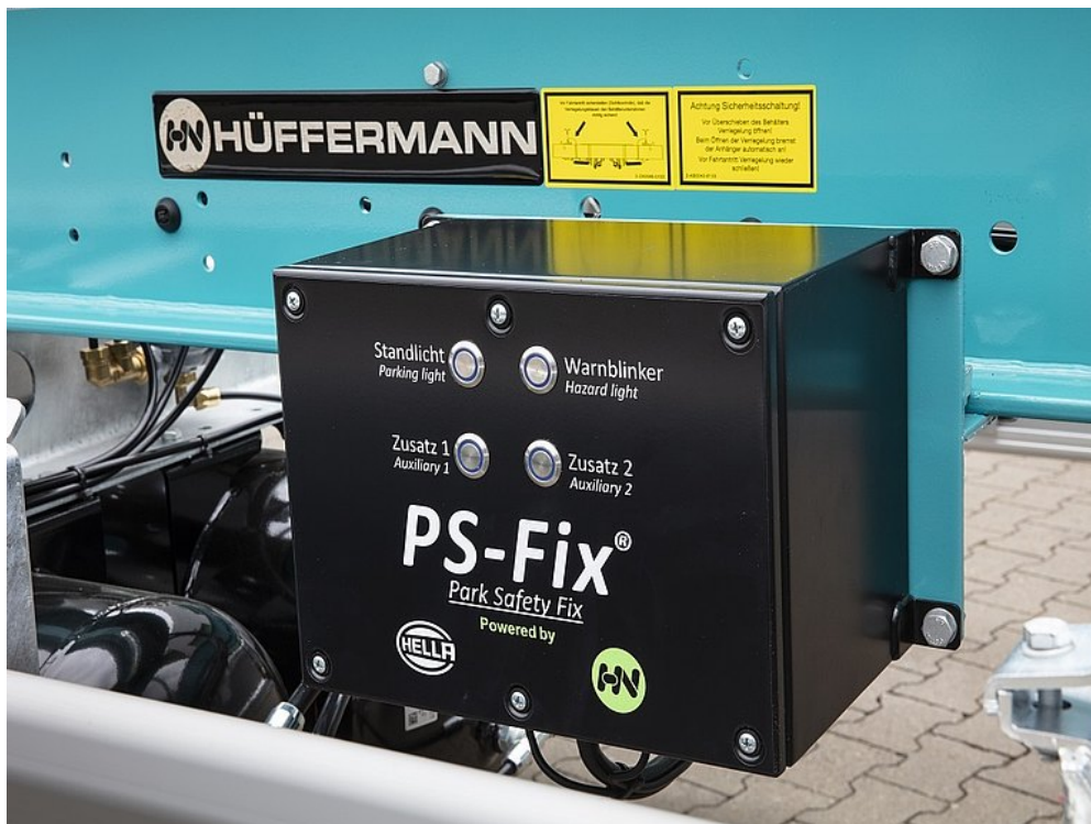
System oświetlenia z własnym zasilaniem w celu zapewnienia większego bezpieczeństwa
