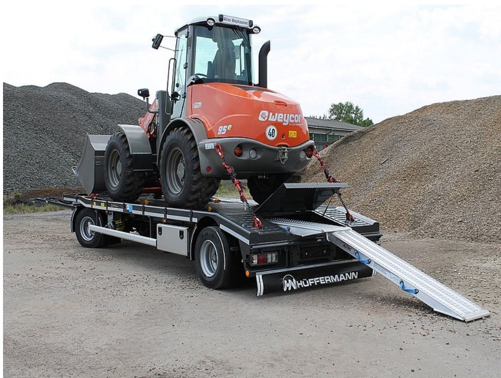
Mocowanie maszyn budowlanych
