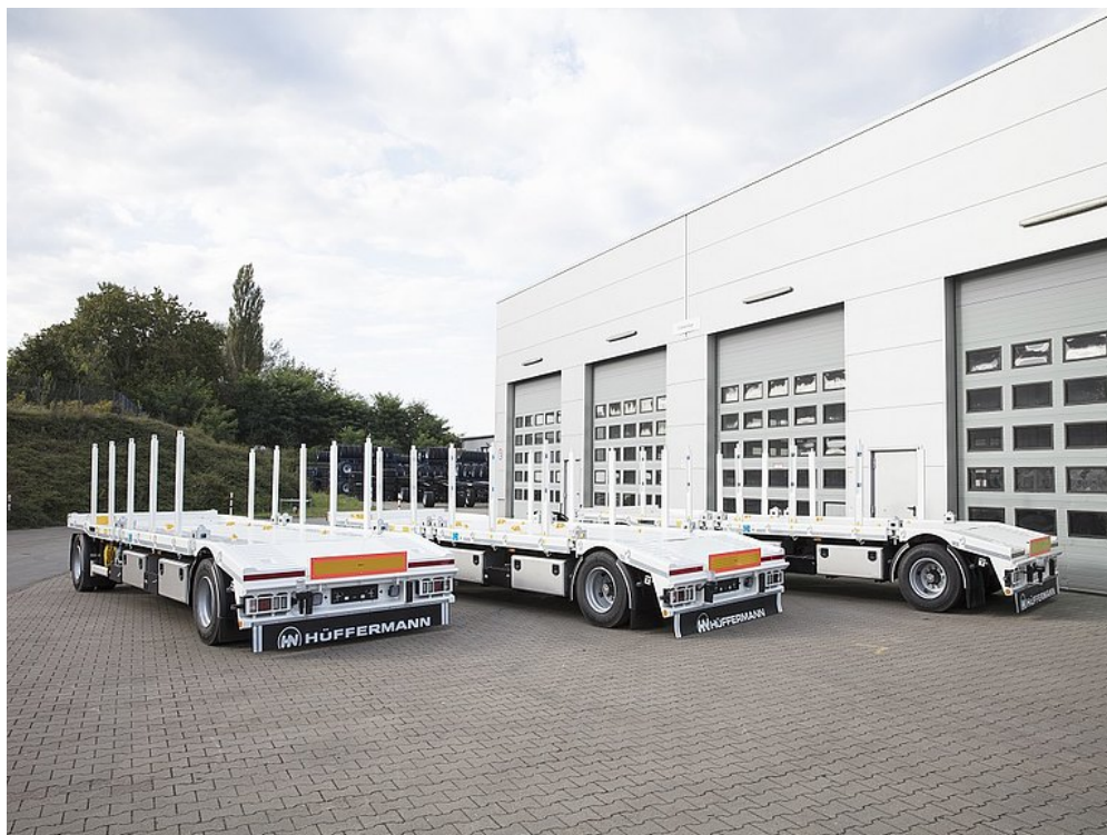
OPCJA WYPOSAŻENIA: Wyposażenie do kontenera ISO i kłonicie
