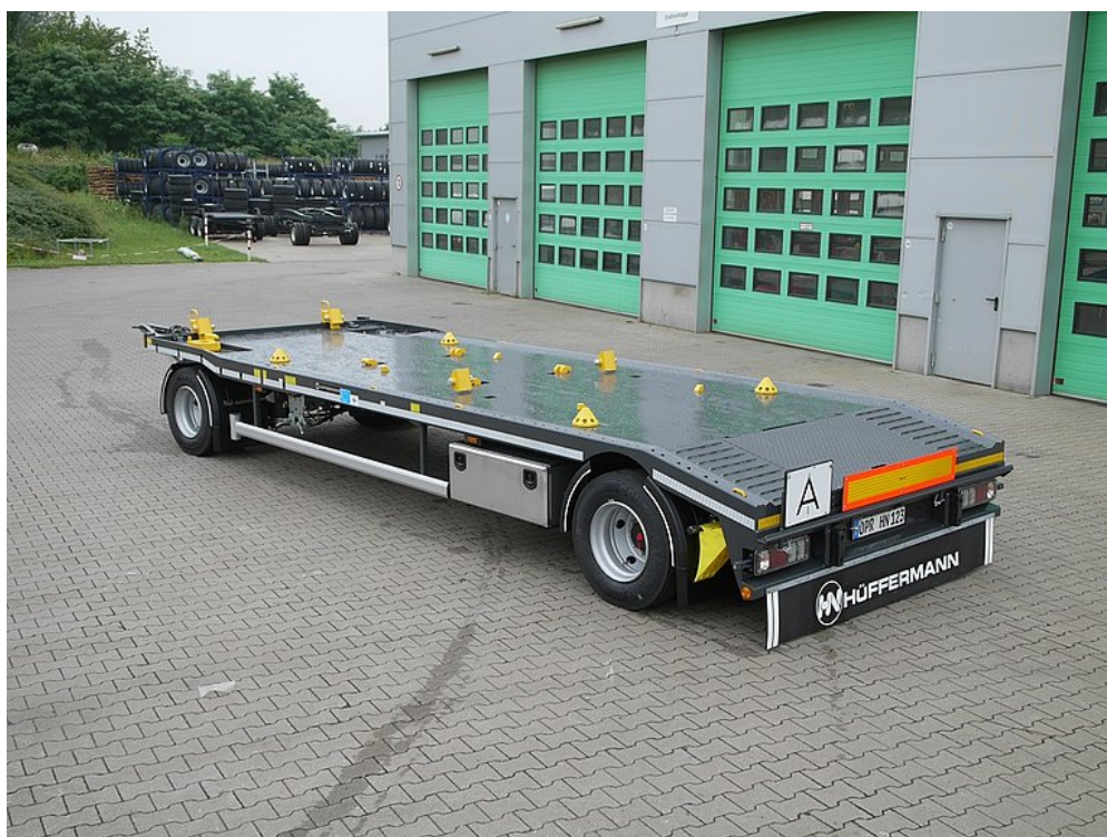
Zewnętrzna rama z opuszczanymi punktami mocowania i wyposażeniem ASK
