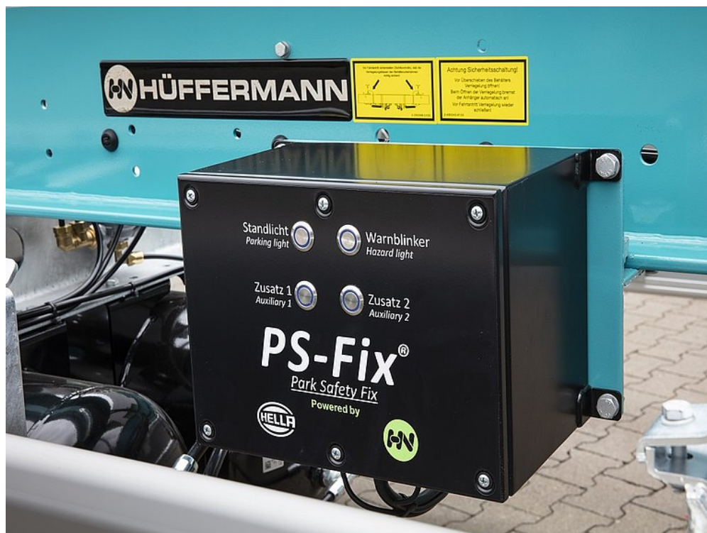
OPCJA WYPOSAŻENIA: System oświetlenia z własnym zasilaniem w celu zapewnienia większego bezpieczeństwa
