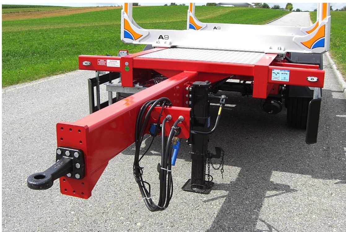
Regulowany na wysokości drąg ciągowy do sprzęgu typu ciężkiego osi centralnej
