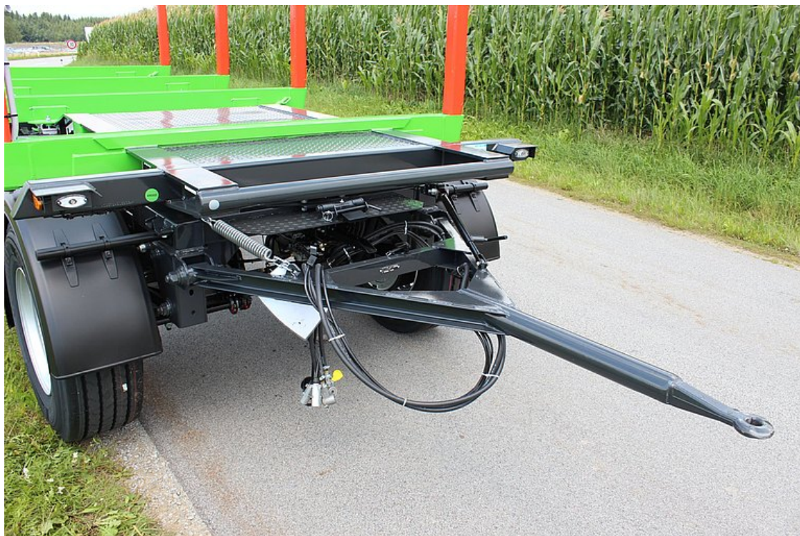
Z przodu wózek skrętny z zamontowanym dyszlem
