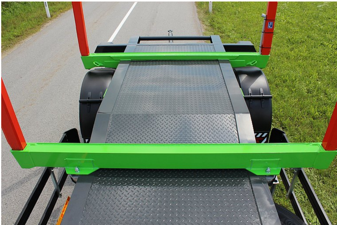
Osłona z blachy stalowej o żeberkach owalnych między podłużnicami ramy
