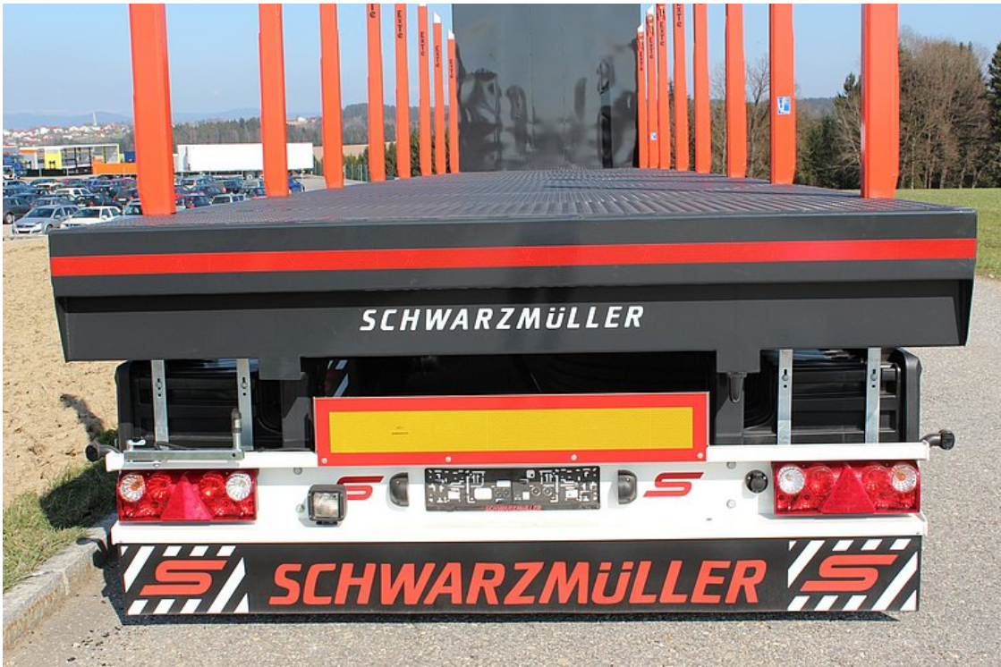
Tyłny koniec z zamontowaną aluminiową osłoną przeciwnajzdową
