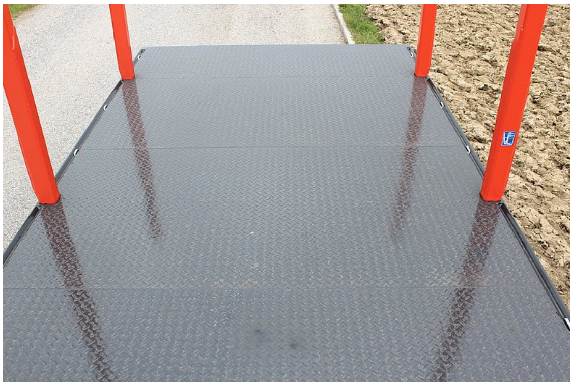
Podłoga z blachy stalowej o owalnych żeberkach 5/7 mm. spawana szczerpie
