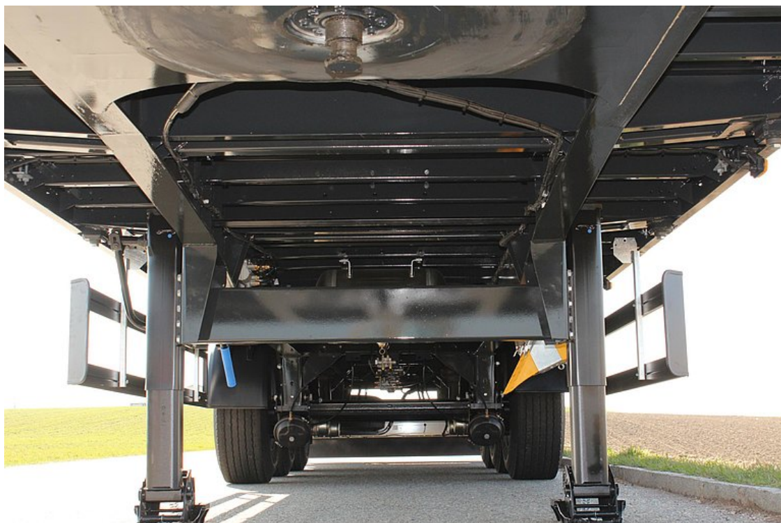
Rama typu lekkiego ze stali specjalnej NAXTRA o wysokiej wytrzymałości i dzięki temu większa ładowność o 500 kg
