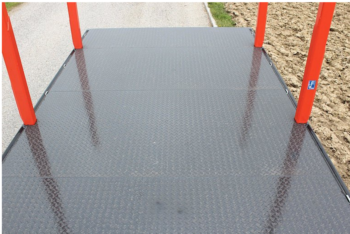
Podłoga z blachy stalowej o owalnych żeberkach 5/7 mm. spawana szczepnie
