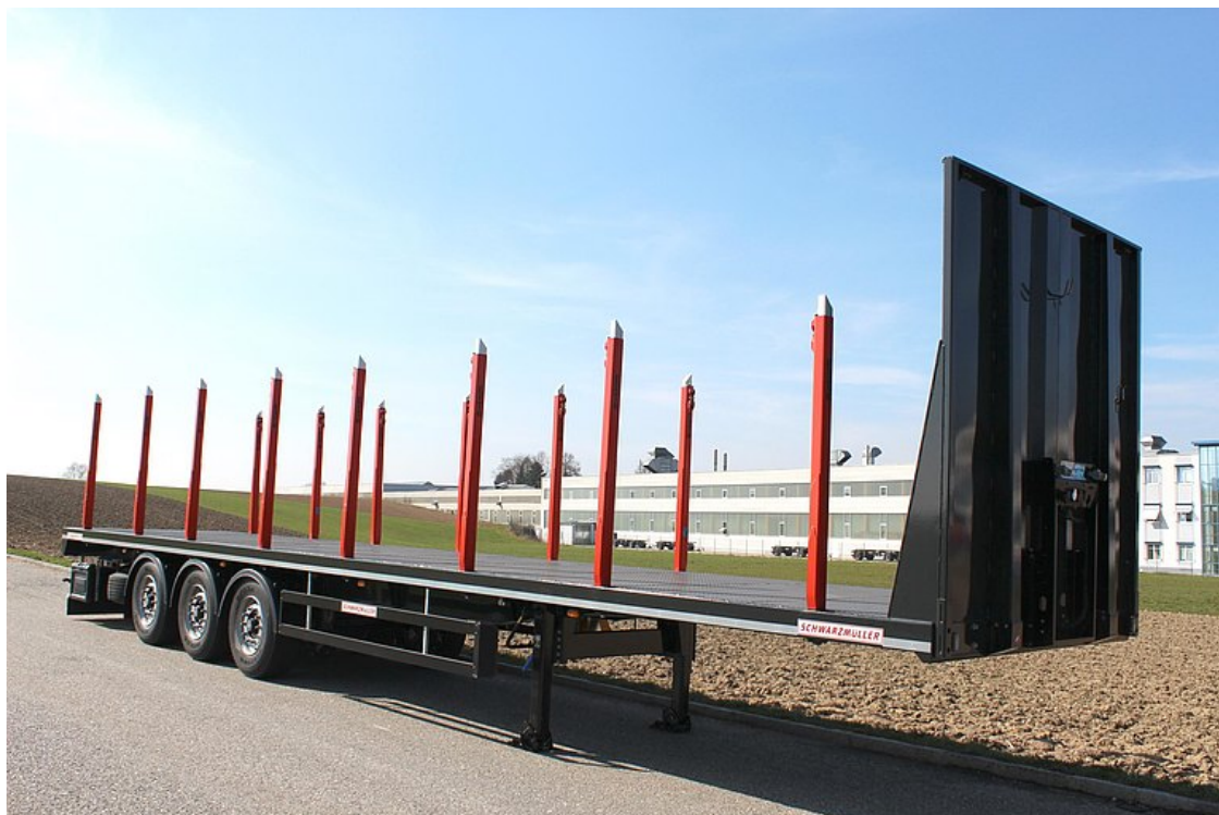
3-osiowa naczepa siodłowa kłonicowa z platformą
