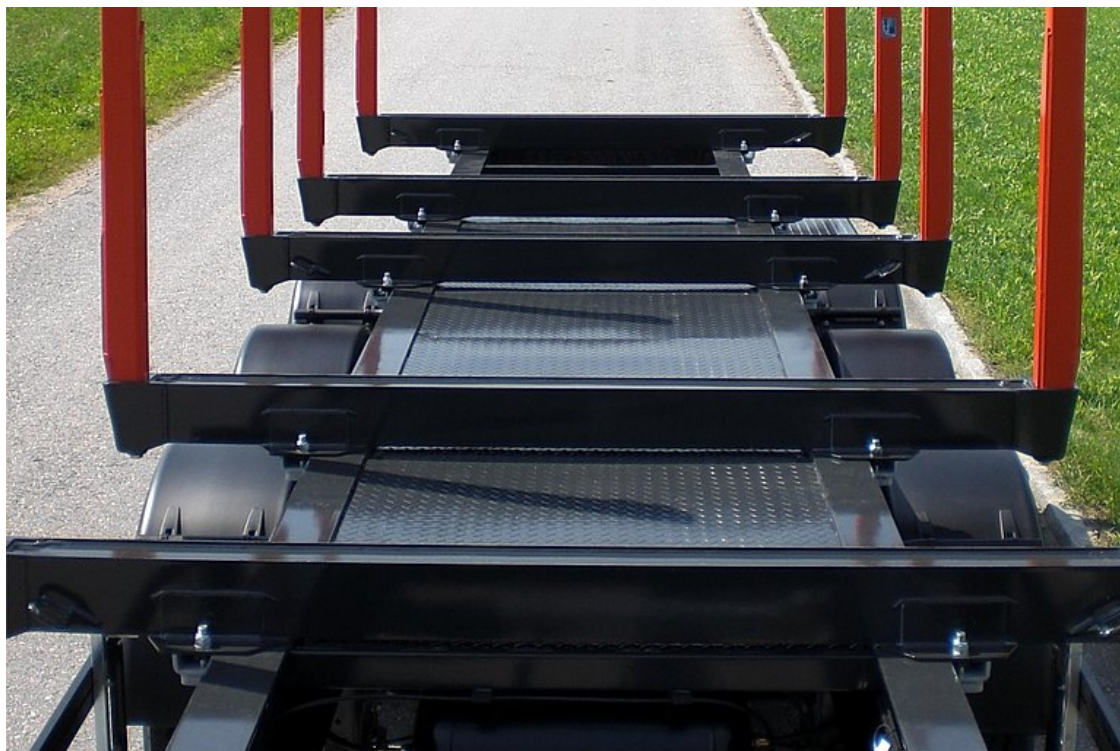
Ośłona ze stalowej blachy z owalnymi żeberkami między podłużnicami ramy nad podwoziem i z przodu
