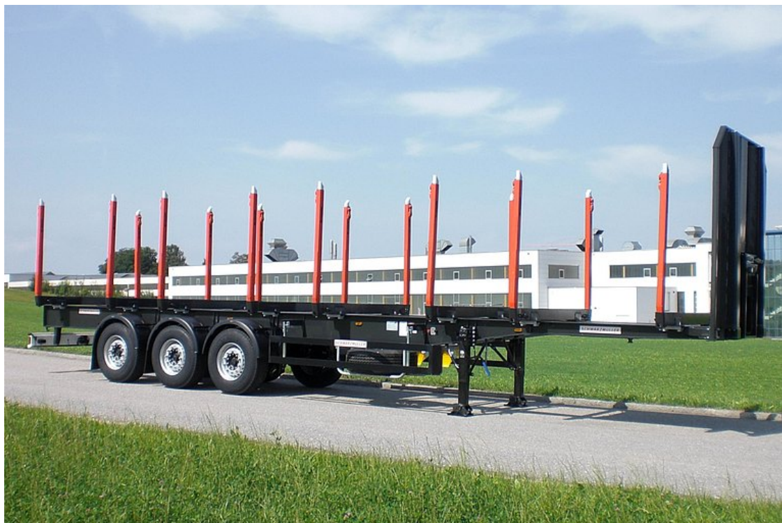
3-osiowa naczepa siodłowa kłonicowa bez platformy
