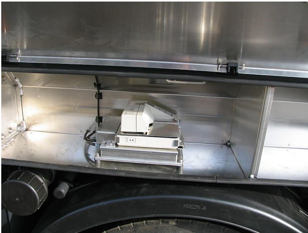
Aluminiowa skrzynka zabezpieczająca drukarkę
