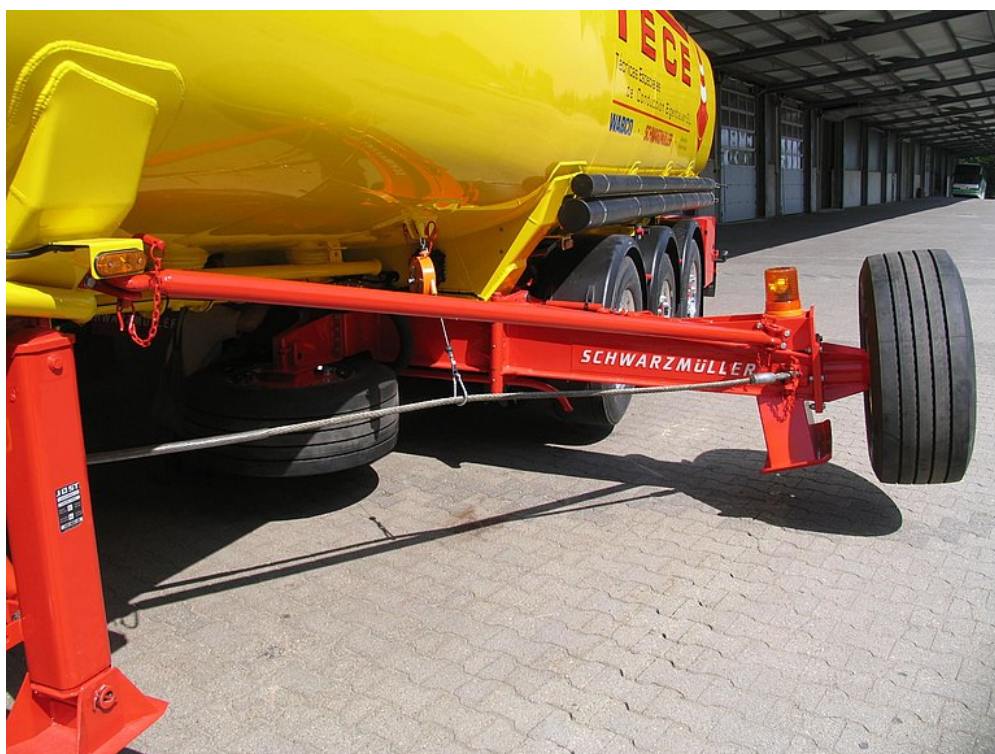
Wysięgnik z urządzeniem przeciwwzgięciowym wraz z liną przeciwwzgięciową i światłem obrotowym na ramie podwozia z lewej strony
