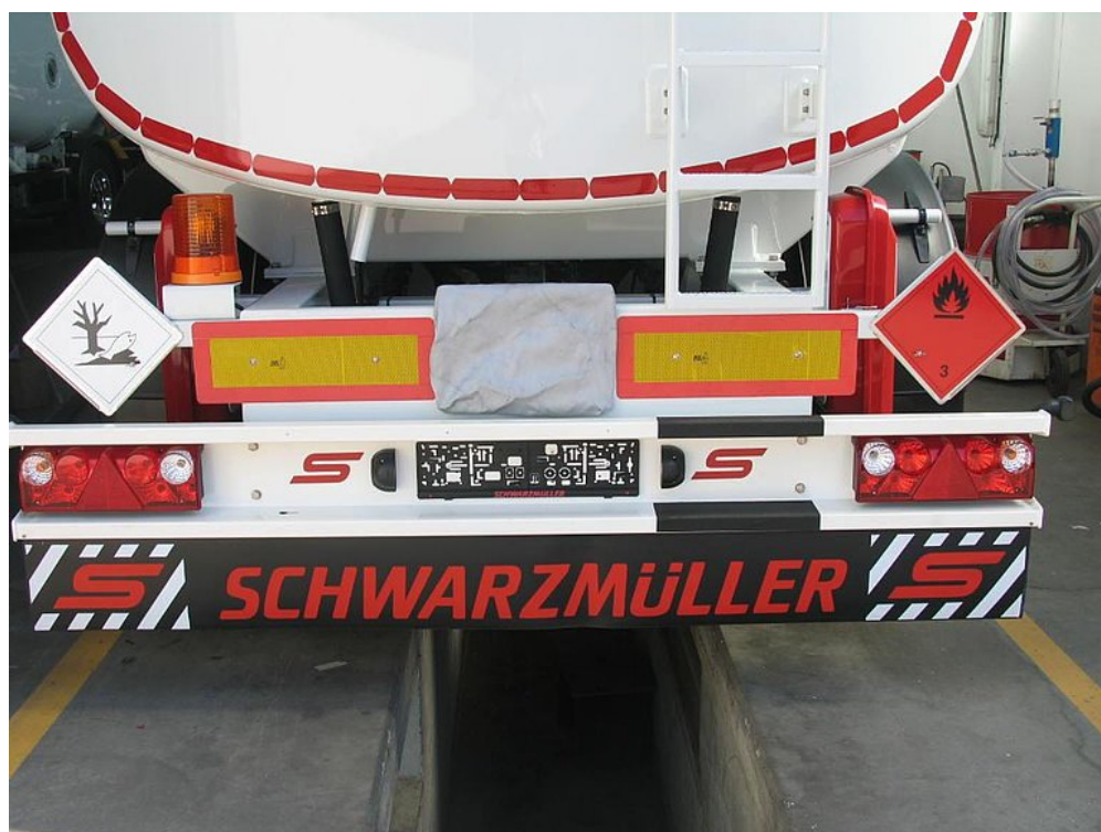
OPCJONALNIE: możliwość wyboru między zderzakiem aluminiowym a ze stali szlachetnej
