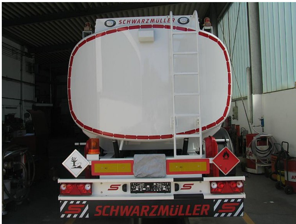
OPCJONALNIE: wysoko ustawione światła zintegrowane z miską wjazdu
